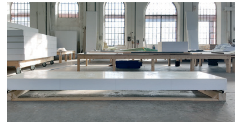
Sandwichelement mit einer Stärke von 20 cm | Foto: Ruben Heiming
