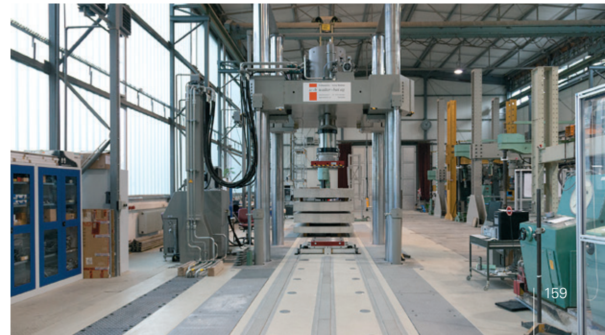
10-MN-Säulenprüfmaschine mit Aufspannfeld | 10 MN testing machine with strong-floor | Photo: Ulrich van Stipriaan
