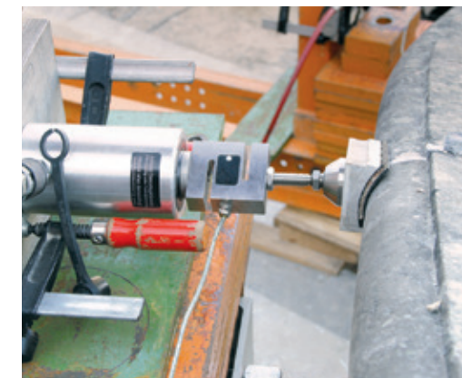
Hydraulikzylinder und Passstück des Handlaufs | Detail of the load application point | Photo: Sabine Wellner
