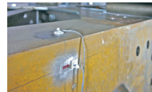
Messung der Stahldehnungen mit Dehnmessstreifen | Strain recording with strain gauges | Photo: Robert Schneider
