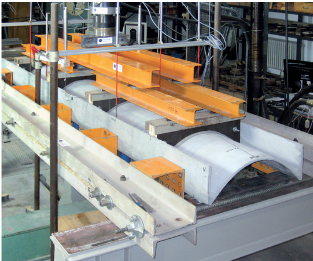
Test der Deckenelemente aus betongetränkten Vliesstoffen und Carbonbeton | Foto: Michael Frenzel
