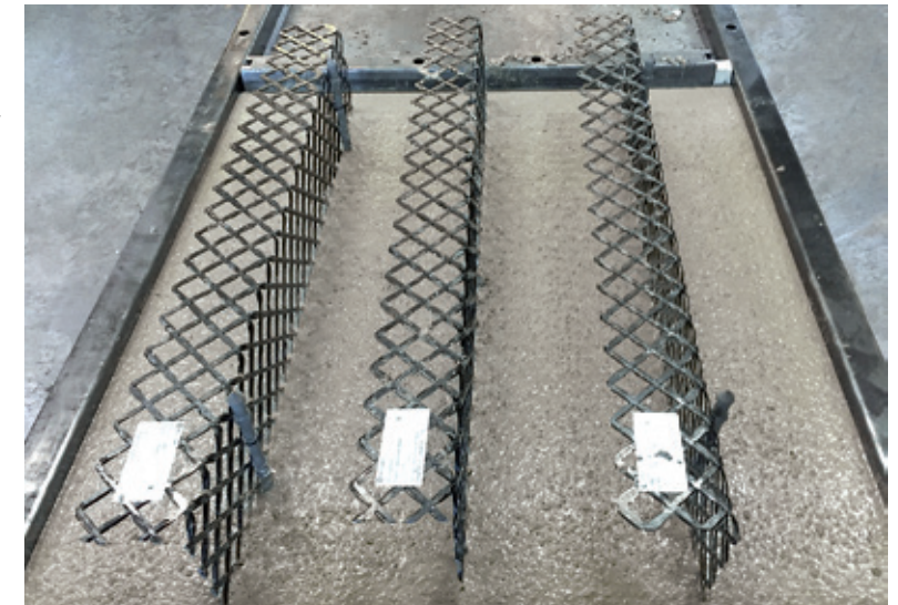
Wandhalbfertigteil in Carbonbetonbauweise | Foto: Matthias Tietze
