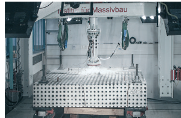
Bildsequenz des Aufpralls eines beschleunigten Projektils | Sequence of frames of a projectile impact | Photos: Tino Kühn
