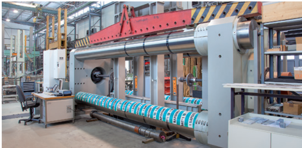
Der 20-MN-Belastungsrahmen | 20 MN load bearing frame | Photo: Sven Hofmann
