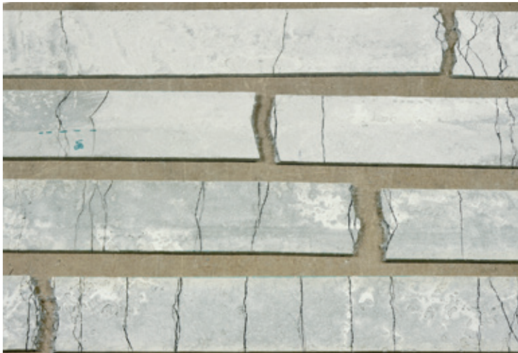
Dehnkörper mit unterschiedlich hohen Faseranteilen und Rissabständen | Tensile specimens with different ratios of fibres and crack distances | Photo: Tilo Senckpiel
