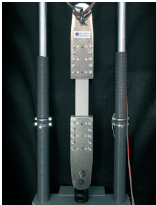
Aufbau eines zyklischen Zugversuches | Setup of a cyclic tensile test | Photo: Doreen Sonntag
