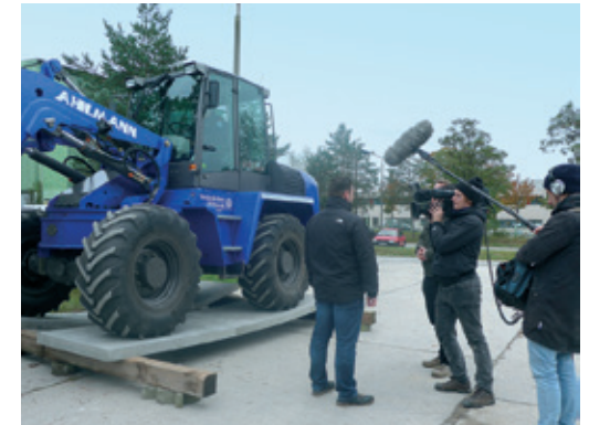
12 Tonnen Gewicht sind eine hohe Belastung für die beiden Betonplatten. | Foto: Sandra Kranich
