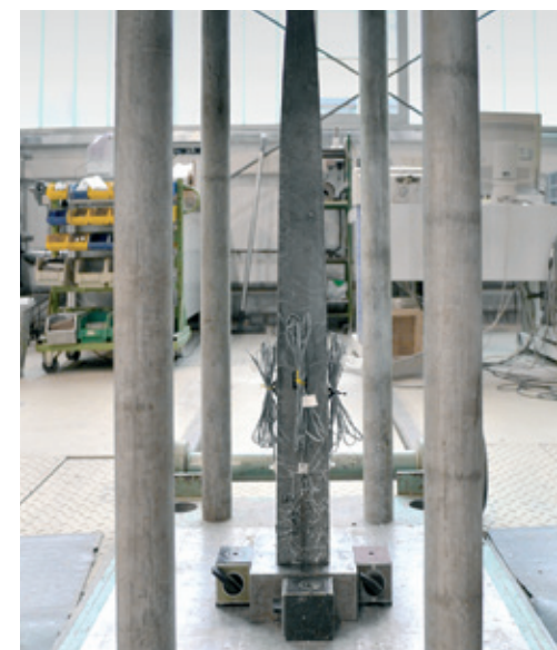
Fußbereich einer in die Säulenprüfmaschine eingebauten formoptimierten Stütze | Bottom area of a form optimised column in the testing machine | Photo: Angela Schmidt
