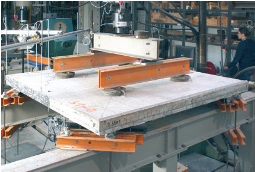
Prüfaufbau für zwei-achsig gespannte Platten | Experimental setup for two-way spanned slabs | Photo: Michael Frenzel
