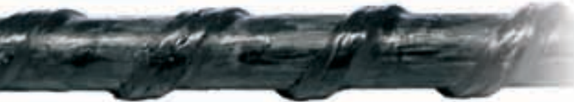
Bewehrungsstab aus Faserverbundkunststoff | Foto: Alexander Schumann
