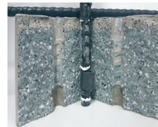
Abgeschnittene Carbonrippen nach Ausziehversuch am Carbonstab | Sheared carbon ribs after pull-out test on carbon rod | Photo: Robert Zobel
