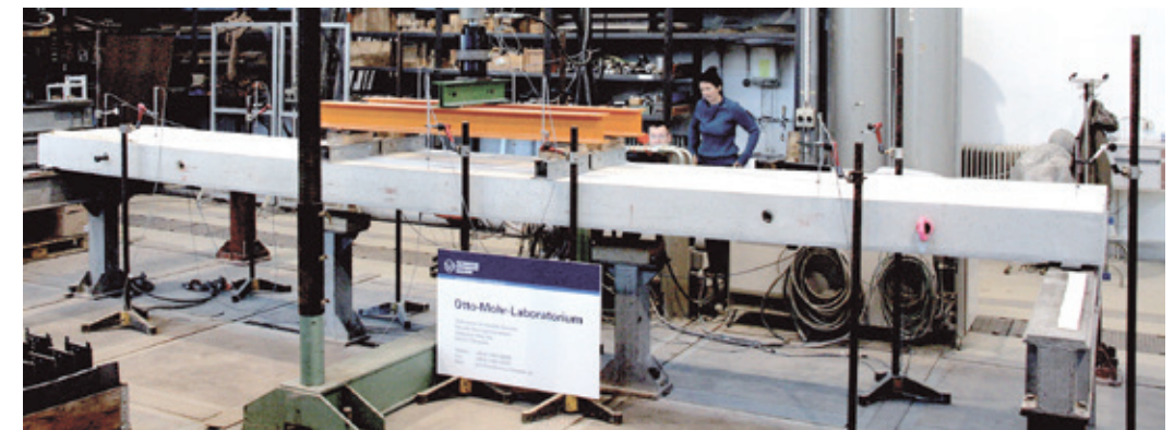
Versuch an einer textilbetonverstärkten Platte | Foto: Otto-Mohr-Laboratorium
