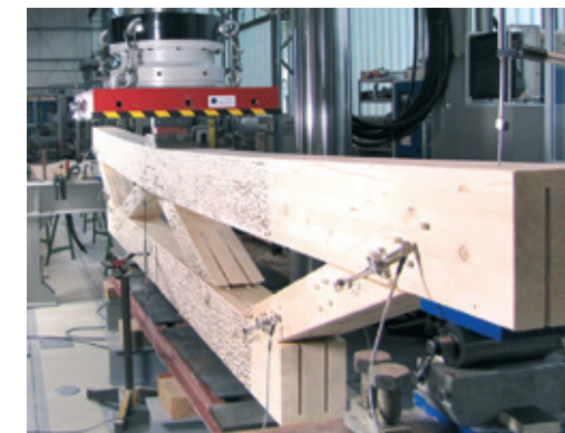
Durchbiegung des Holzfachwerks während des Biegeversuchs | Deflection of the truss during the bending test | Photo: Siavash Namari
