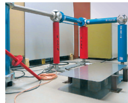
Lagerung der Betonproben im Gleichstromfeld | Storage of the concrete specimen in the DC field | Photo: Maher Bakka
