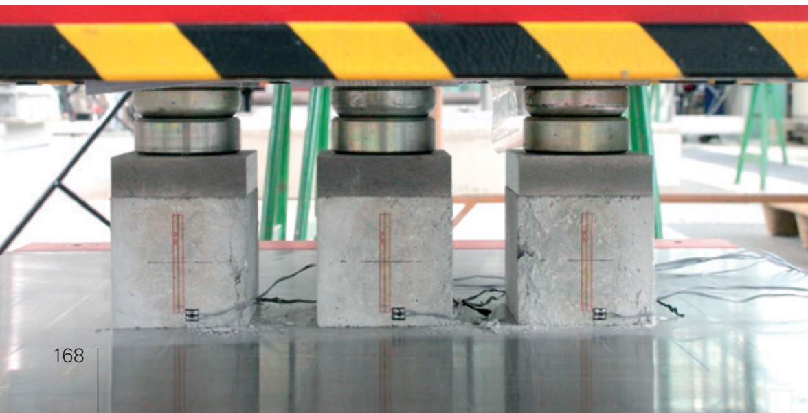
Prüfwürfel nach 30 Millionen Lastwechseln | Cubic samples after 30 million load cycles | Photo: Doreen Sonntag
