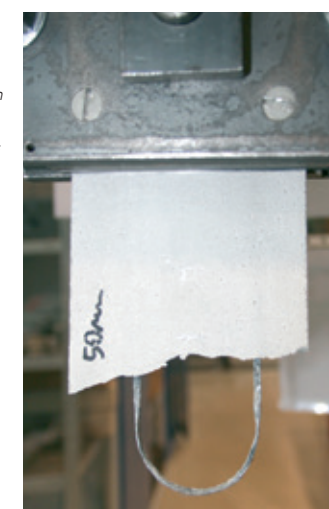
Betonversagen bei einer Übergreifungslänge von 5 cm | Concrete failure with an overlapping length of 5 cm | Photo: Mateusz Ewertowski
