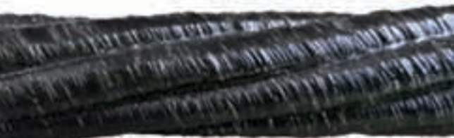
Litze zum Vorspannen aus carbonfaserverstärktem Kunststoff | Foto: Kerstin Speck
