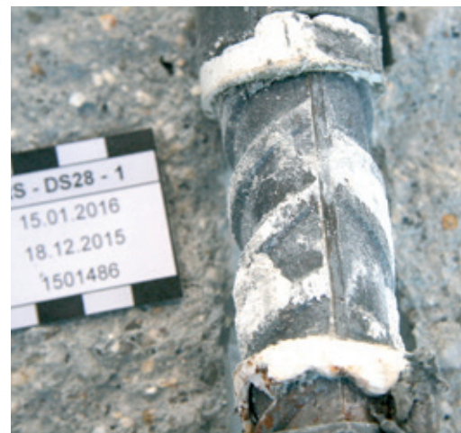
Verbundzone zwischen Bewehrungsstahl und Beton nach dem Auszugversuch | Foto: Tobias Hein
