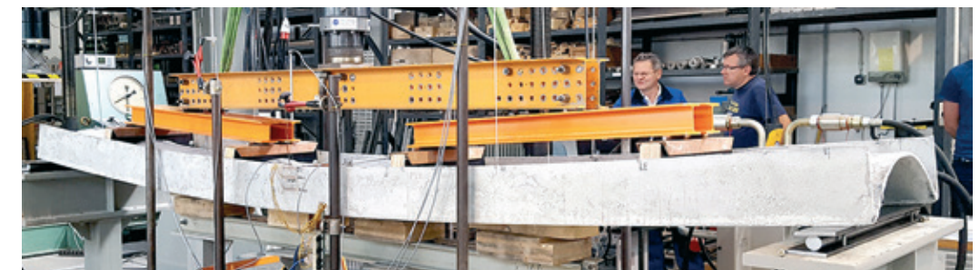
6-Punkt-Biegeversuch an einem 4,5 m langen Deckenelement | 6-point bending test on a 4.5 m ceiling element | Photo: Tilo Senckpiel
