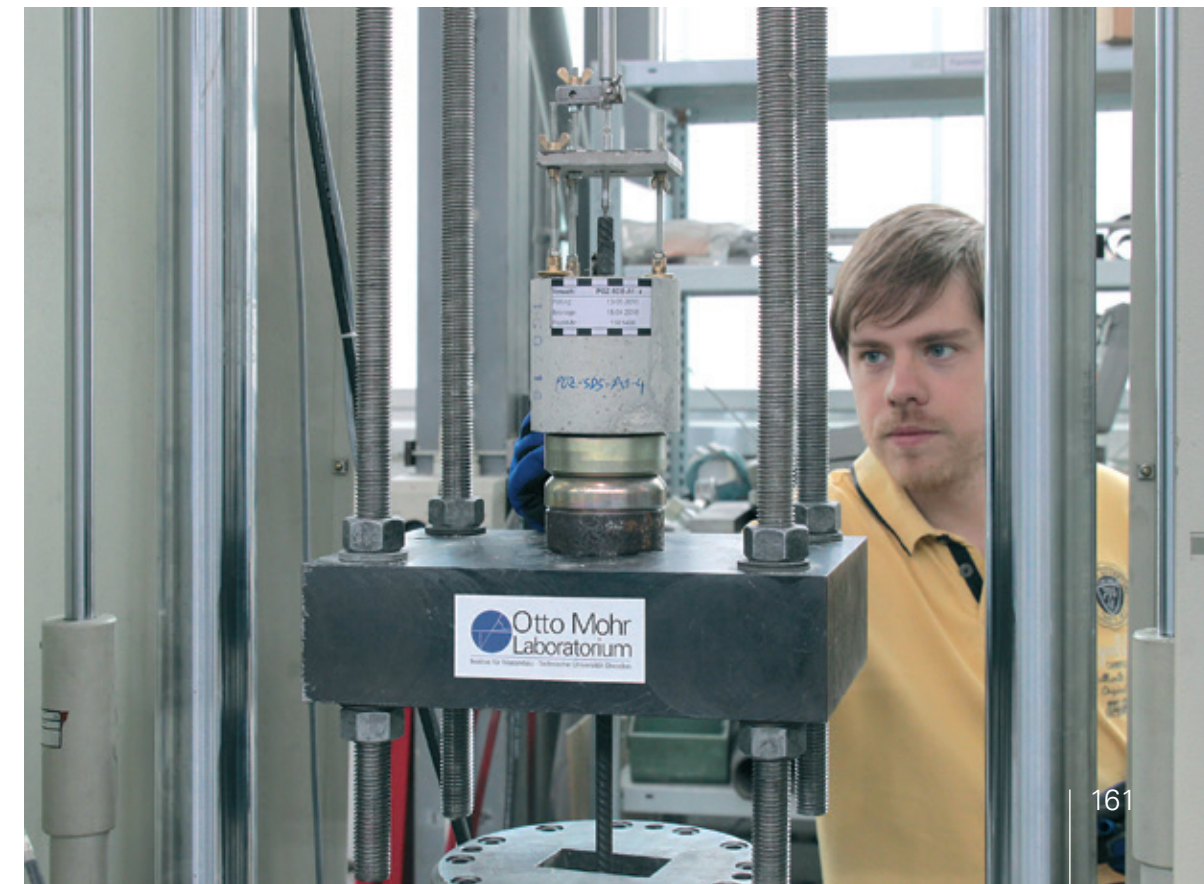
Auszugversuch an Bewehrungsstahl | Pull-out test on steel reinforcement | Photo: Heiko Wachtel
