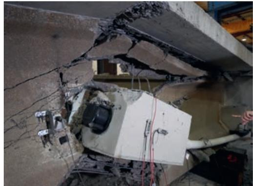
Querkraftversagen im Bereich der Ankerblöcke für die nachträgliche externe Vorspannung | Foto: Lena Leicht
