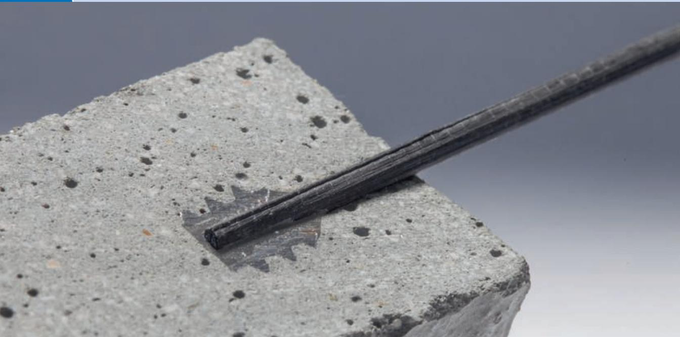
Mechanisch wirkende Verankerungsstruktur im Verbund zwischen Carbonfaserstrang und Beton | *Mechanical anchoring structure in bond between carbon fiber yarn and concrete* | Photo: Stefan Gröschel
