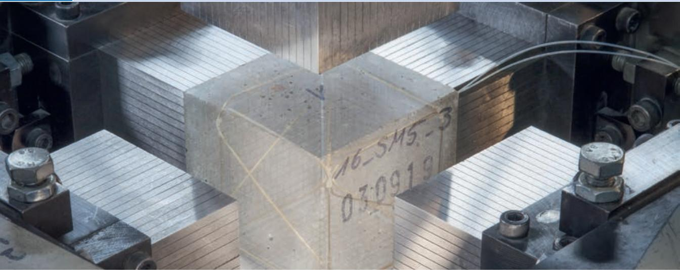
Probekörper mit faseroptischem Sensor in der Triaxialprüfmaschine | Test specimen with fiber optic sensor in triaxial testing machine | Photomontage: Stefan Gröschel
