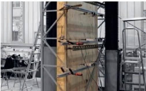
Ermittlung der vertikalen Tragfähigkeit im Druckversuch | Determining the vertical load capacity in a compression test | Photo: Konrad Kallenowsky
