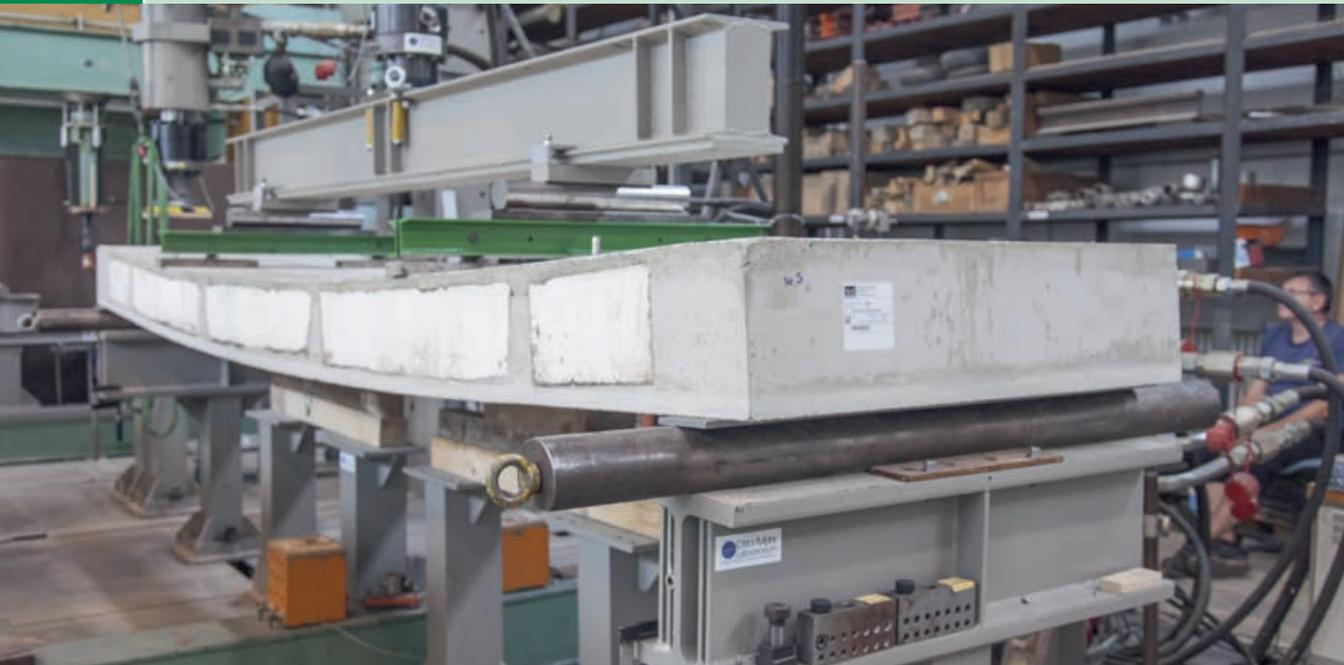
4-Punkt-Biegeversuch einer mit EPS gefüllten Hohlkörperdecke aus Carbonbeton | 4 point-bending test of a hollow slab filled with EPS | Photo: Stefan Gröschel
