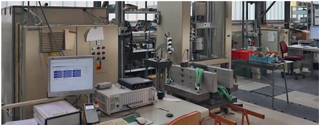
Prüfmaschine Schenck 250 kN | *Testing machine Schenck 250 kN* | Photo: Thomas Häntzschel
