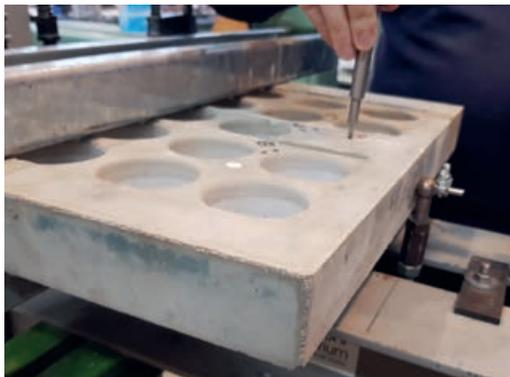
Bauteil mit Hohlräumen zur Funktionsintegration im Versuchsstand | Building element with cavities for function integration in a test facility | Photo: Dominik Schlüter
