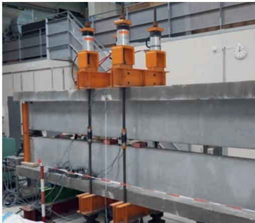
Für die Prüfung der Querkrafttragfähigkeit unter Dauerlast wurden zwei Bauteile gegeneinander gespannt | To test the shear capacity under permanent loads two structures were braced against each other | Photo: Elisabeth Schütze
