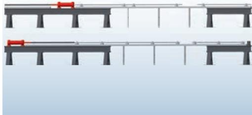
Konfigurationen des Split-Hopkinson-Bars: Zug- (oben) und Druckkonfiguration (unten) | Split Hopkinson bar configurations: tensile (top) and compressive (bottom) configuration | Graphic: Lena Leicht
