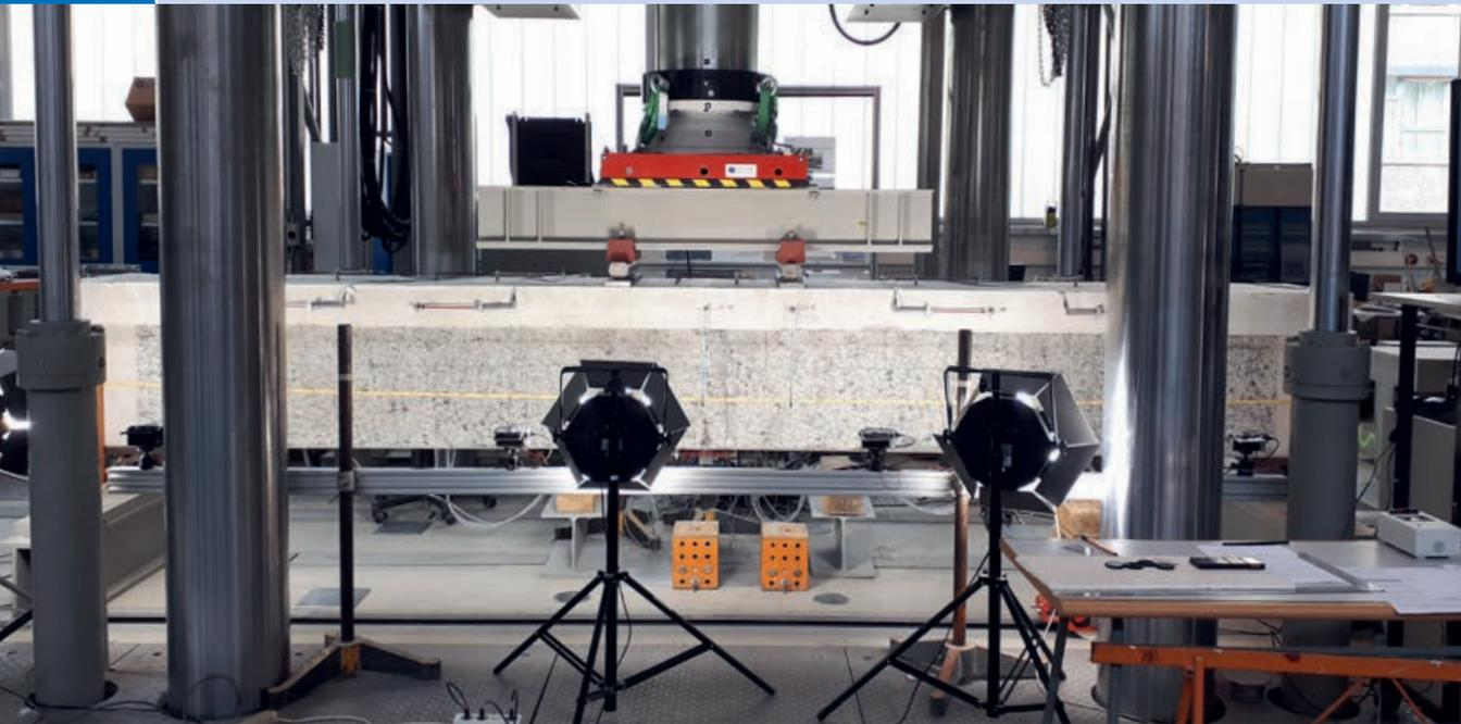
Versuchsaufbau der verstärkten Plattenbalken | Test setup for strengthened T-beams | Photo: Sebastian May
