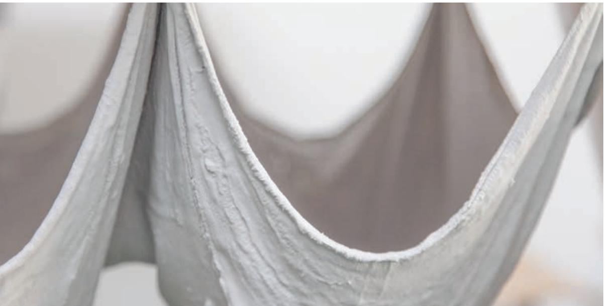
Workshop zur Formfindung für Schalenträgerwerke mit Hängemodellen aus Gips | *Form finding workshop for shell structures with hanging models made of plaster* | Photos: Stefan Gröschel
