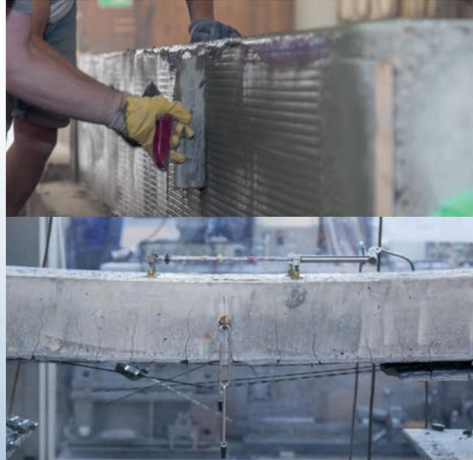
Entwurf Arbeitspapier Bemessung (links); mit Carbonbeton verstärkte Stahlbetonplatte (rechts) | Draft working paper Dimensioning (left); steel reinforced concrete slab strengthened with carbon reinforced concrete (right) | Photos: Stefan Gröschel
