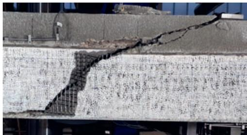
Querkraftversagen eines Plattenbalkens mit carbonbetonverstärktem Steg | Foto: Sebastian May
