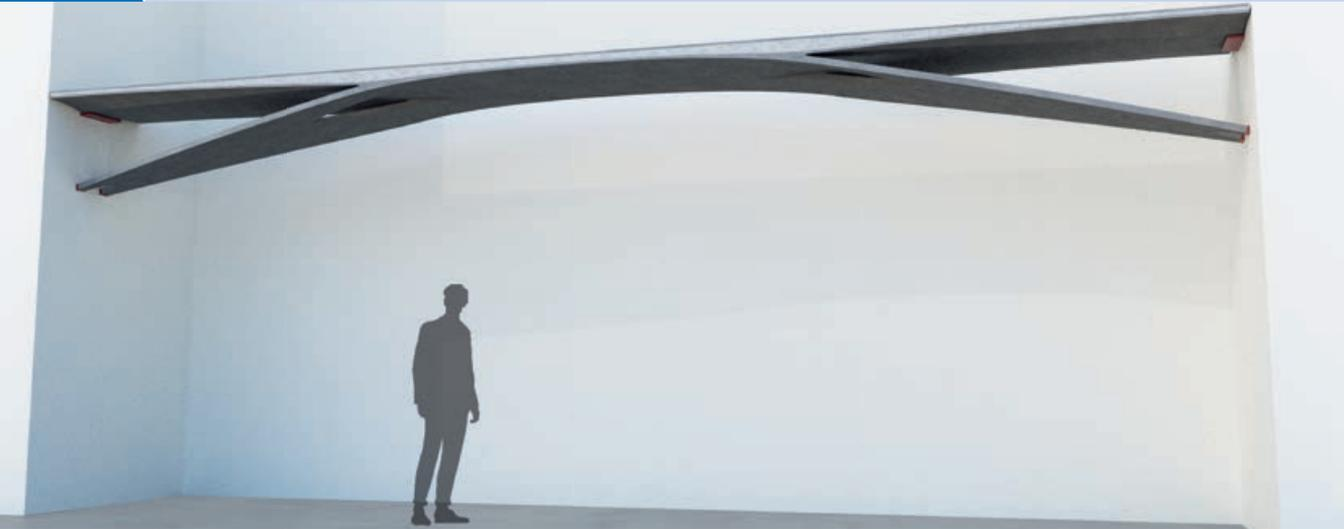
Visualisierung der Ausstellungsbrücke aus Carbonbeton | Visualization of the carbon concrete exhibition bridge | Rendering: Iurii Vakaliuk
