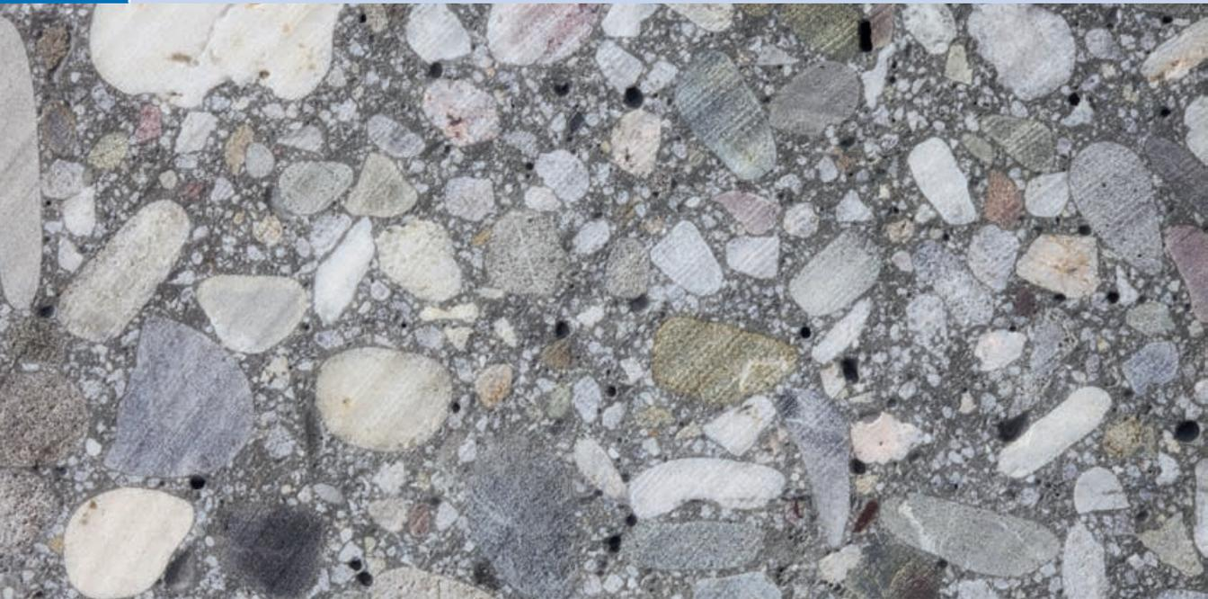
Heterogenität des Betons | *Heterogeneity of concrete* | Photo: Stefan Gröschel
