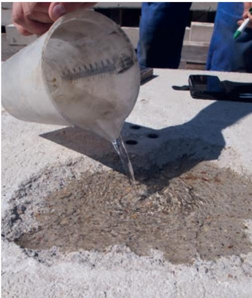
Durchlässigkeitsprüfung unter atmosphärischem Druck | *Permeability test under atmospheric pressure* | Photo: Franz Bracklow
