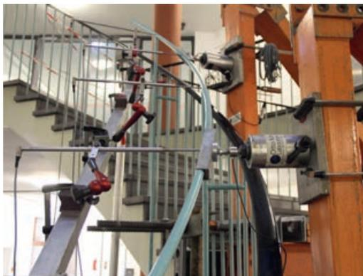
Hydraulikzylinder und Passstück des Handlaufs | Detail of the load application point | Photo: Sabine Wellner
