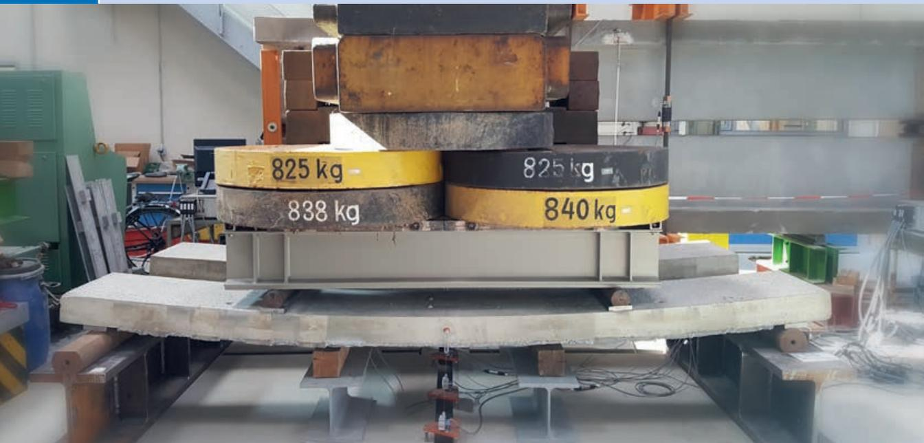
Bauteile im Biegeversuch können mehrere Tonnen an Gewicht über einen langen Zeitraum tragen | Structures under bending loads can withstand quite high loads over a long period of time | Photo: Elisabeth Schütze
