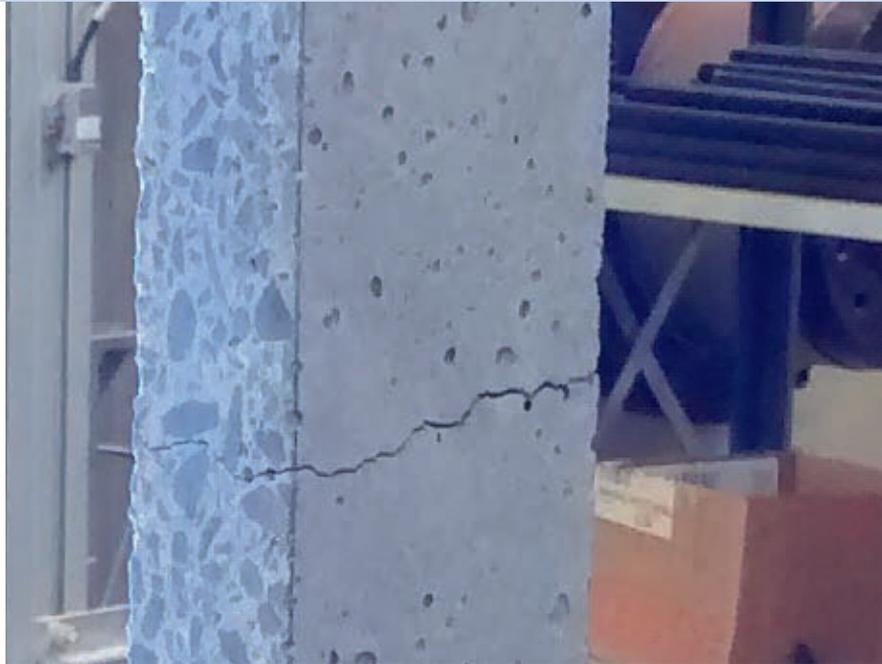
Rissbild eines Dehnkörpers aus Carbonbeton | Crack pattern in a specimen of carbon concrete under tension | Photos: Philipp Riegelmann
