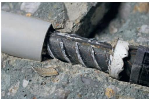
Verbundzone nach Versagen | Bond zone after failure | Photo: Marc Koschemann
