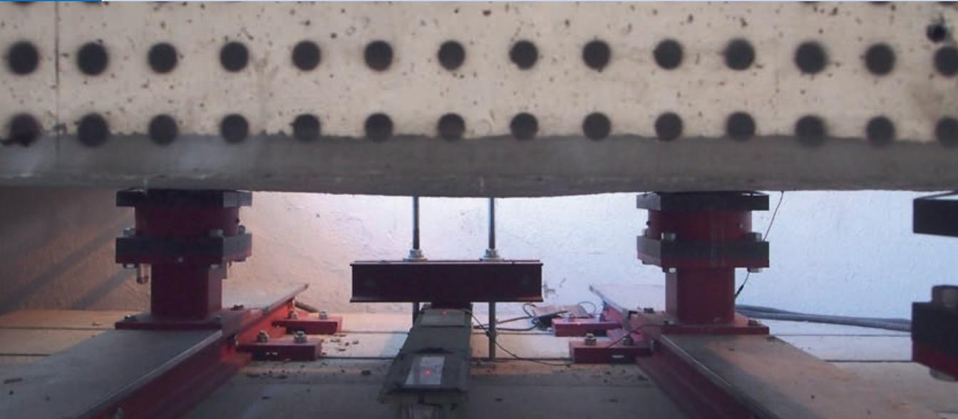
Blick unter den Probekörper nach dem Experiment | View under the specimen after the experiment | Photo: Franz Bracklow
