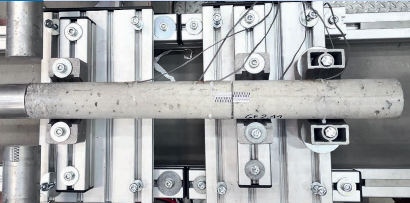
Festbetonprobekörper nach dem Spallationsversuch am Split-Hopkinson-Bar | Test-specimen after a spallation test in the split Hopkinson bar | Photo: Oliver Mosig
