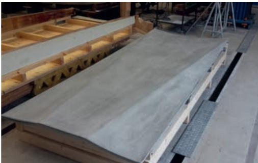
Zweiachsig gekrümmte Carbonbetonschale für die Unterseite der Randfelder | *Biaxial curved carbon concrete shell for the underside of the edge fields* | Photo: Marc Koschemann
