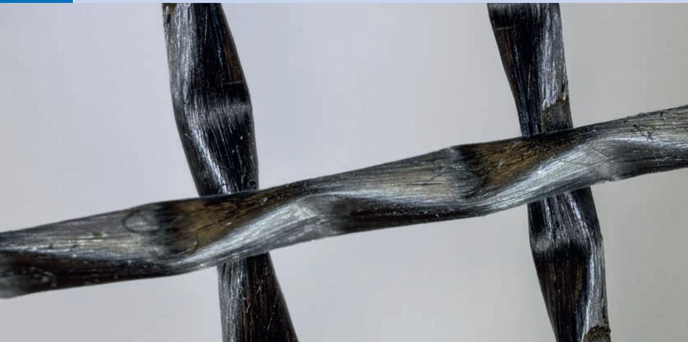
Gitteranordnung der Textilbewehrung aus Profil-Carbonrovings | Grid structure made of profile yarns | Photo: Martin Waldmann
