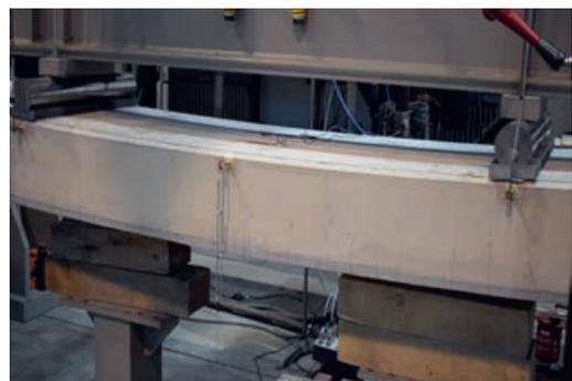
Spannbetonplatte mit Biegeverstärkung aus Carbonbeton im Vier-Punkt-Biegeversuch | Foto: Niclas Oette
