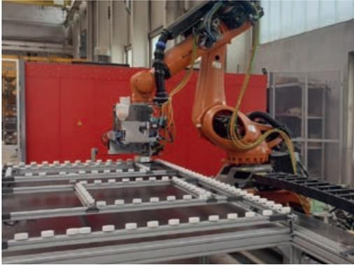
Robotergestützte Herstellung von individuellen Carbonbetonbewehrungsstrukturen | Robot-assisted production of individual carbon concrete reinforcement structures | Photo: Frank Schladitz
