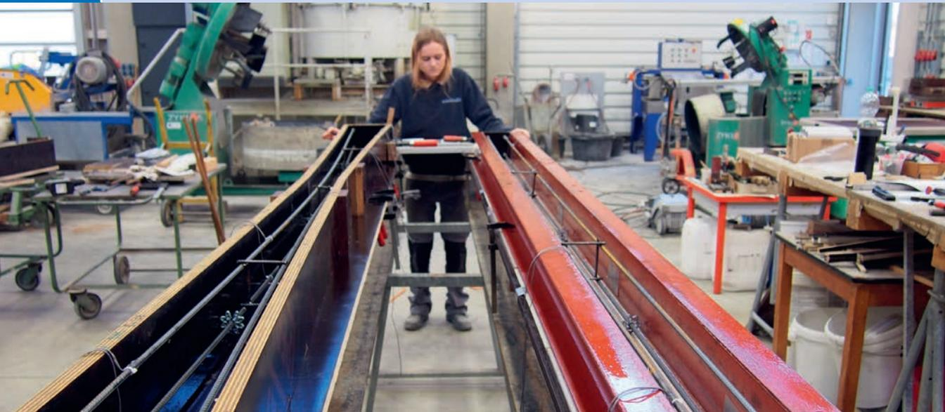
Schalungen für untersuchte Stützenformen bei einer kombinierten Beanspruchung aus Längskraft und Biegung | Formwork for investigated column shapes under a combined load of longitudinal force and bending | Photo: Angela Schmidt
