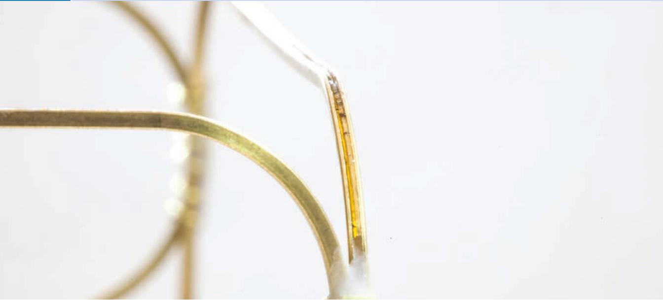
Faseroptische Sensoren, eingebettet in einem Trägergerüst aus Messing-U-Profilen | *Fibre optic sensors embedded in a support frame made of brass U-profiles* | Photo: Stefan Gröschel
