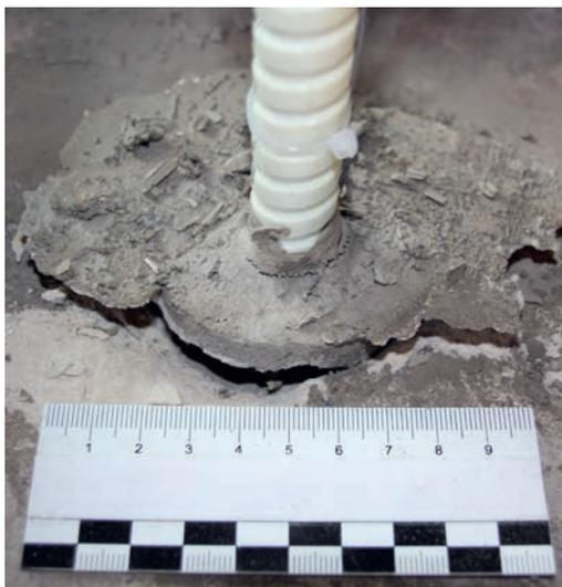
Stab-Ausziehversuch, große Verbundlänge, GFK-Anker, Durchmesser 16 mm | *Bar pull-out test, large bond length GFRK anchor, diameter 16 mm* | *Photo: Hassan Youssef*
