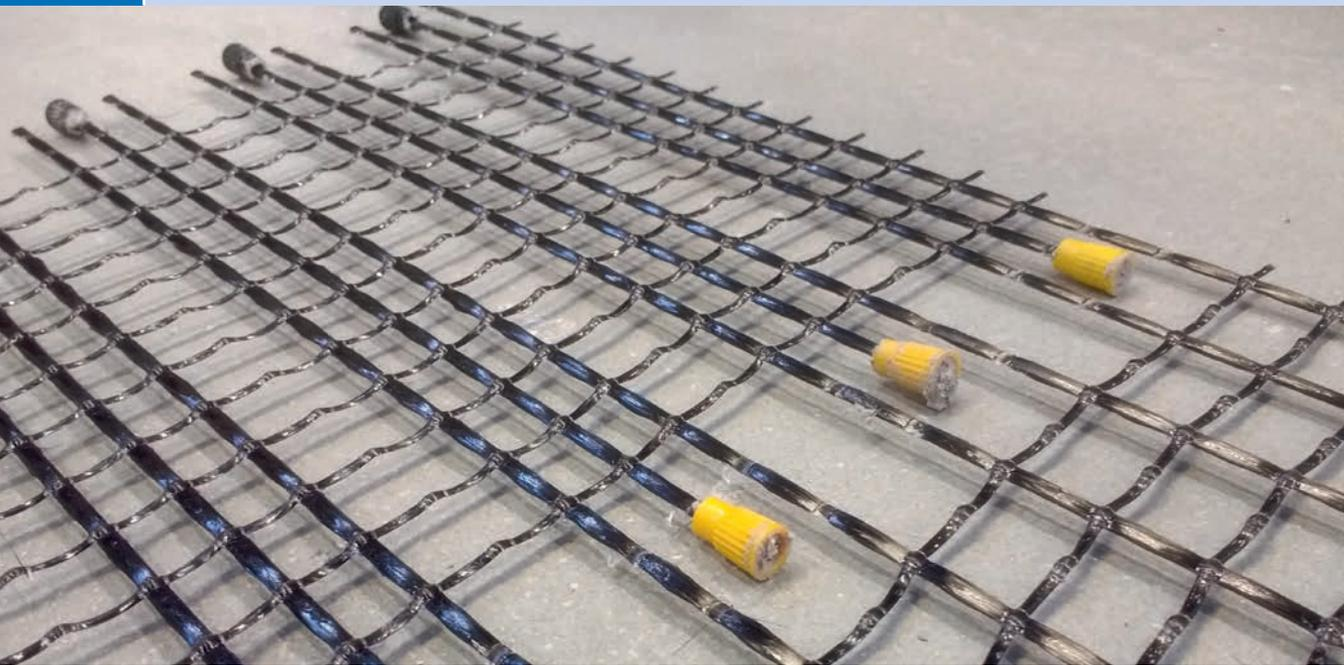
Auf den Garnenden applizierte Verankerungskörper | Anchoring elements applied to the yarn ends | Photo: Maximilian May
