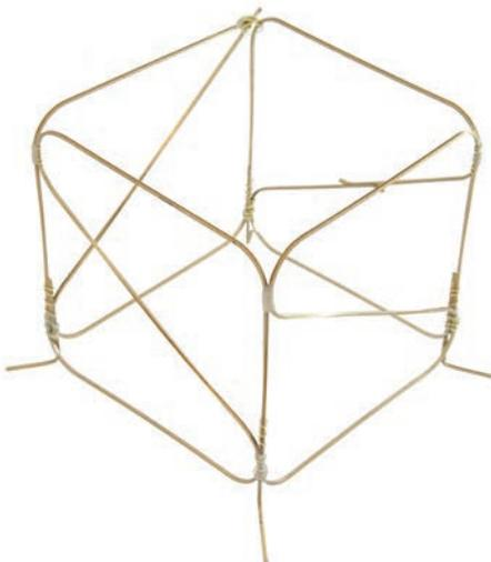
Trägergerüst aus Messingprofilen zur Positionierung des faseroptischen Sensors im Beton | *Support frame made of brass profiles for positioning the fibre optic sensor in the concrete* | Photo: Stefan Gröschel
