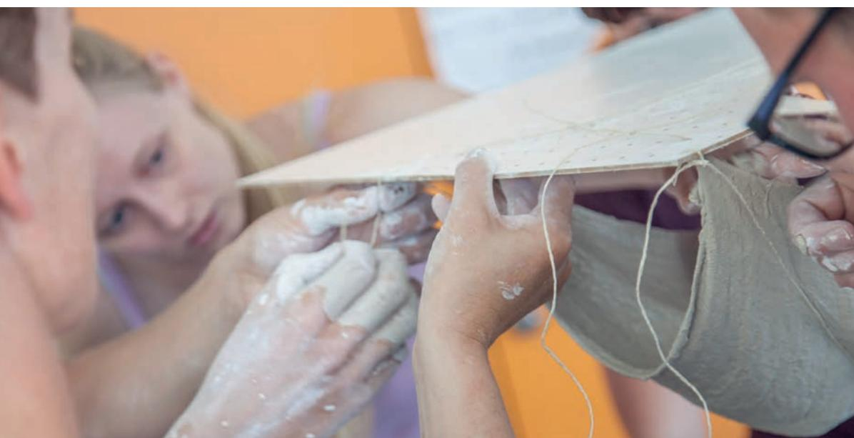
Workshop zur Formfindung für Schalenträgerwerke mit Hängemodellen aus Gips | *Form finding workshop for shell structures with hanging models made of plaster* | Photos: Stefan Gröschel
