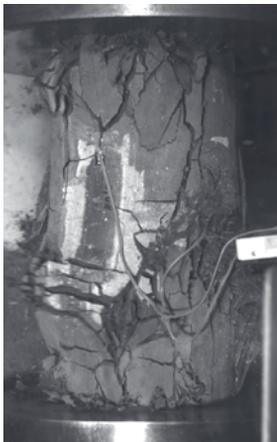
Hochgeschwindigkeitsaufnahme eines Normzylinders aus ultrahochfestem Beton während des Druckversagens | *High speed recording of a standard cylinder made of ultra-high-strength concrete during compression failure* | Photo: Marcus Hering
