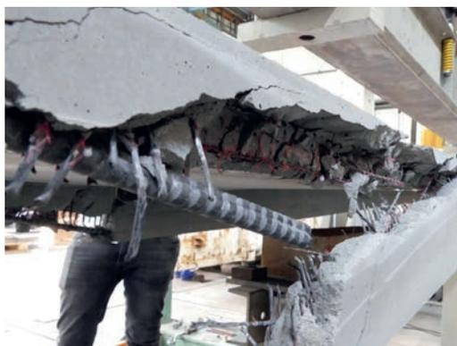
Versagen des Deckenelementes und der Carbonstäbe | Failure of a ceiling element with carbon rebars | Photo: Sebastian May
