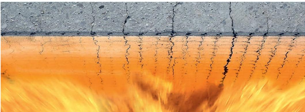
Stahlbetonplatte verstärkt mit Carbonbeton unter Brandbelastung | Steel reinforced concrete slab strengthened with carbon concrete under fire exposure | Photo: Sven Hofmann
