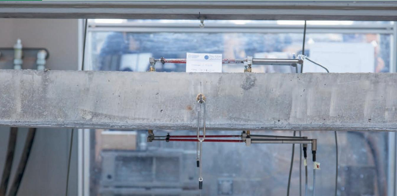
4-Punkt-Biegeversuch einer mit Carbonbeton verstärkten Stahlbetonplatte | 4-point bending test of a steel reinforced concrete slab strengthened with carbon reinforced concrete | Photo: Stefan Gröschel
