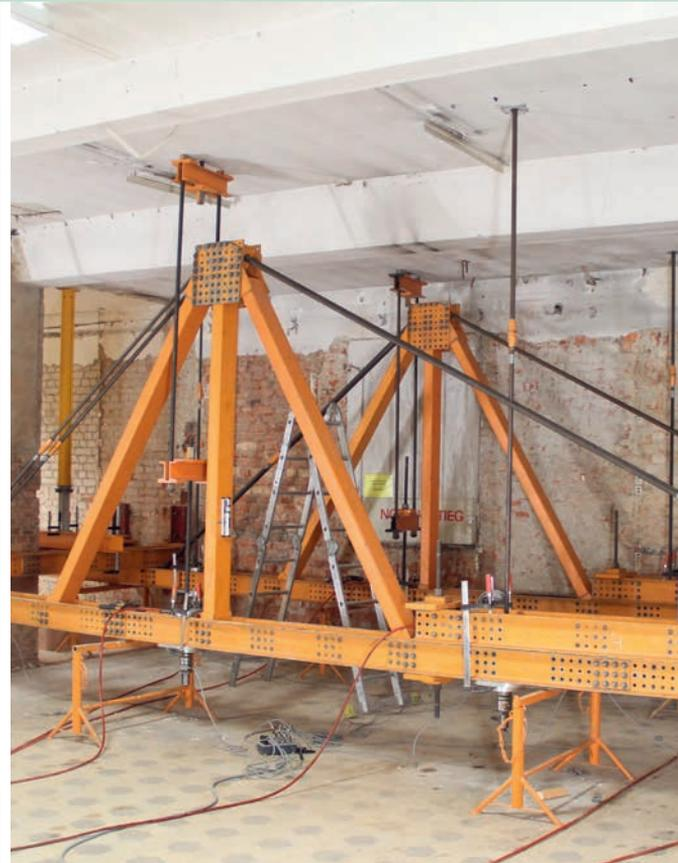
Rahmenkonstruktion zur Lastableitung | Frame construction for load transfer | Photo: Oliver Mosig
