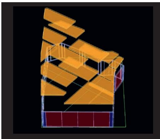
Elementierung von Wand- und Deckenelementen im Gebäudekonfigurator | *Elementation of wall and ceiling elements in the building configurator* | Graphic: Jörg Weselek
