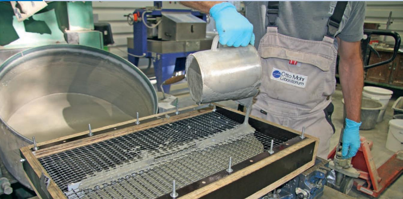
Betonage der gering bewehrten Probekörper | *Concreting of the low reinforced specimens* | Photo: Jakob Bochmann
