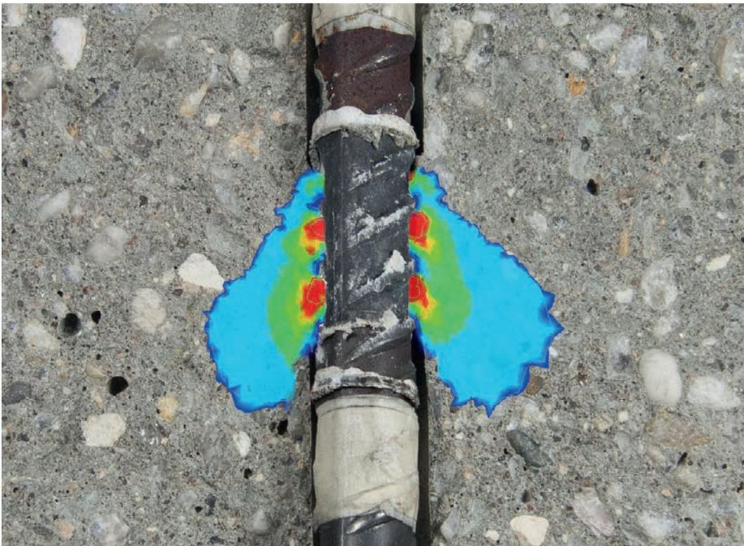
Finite-Elemente-Analyse zum Verbundverhalten auf Rippenebene mit Versuchskörper im Hintergrund | *Finite element analysis of the bond of reinforcement on rib scale with specimen in the background* | Photo: Petr Máca, graphic: Evmorfia Panteki
