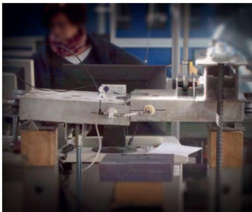
Zug- und Querkraftüberprüfung von zwei gestoßen Carbonbetonplatten | *Testing of tensile and transverse force connection of two carbon plates* | Photo: Franz Bracklow
