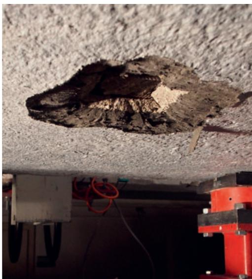
Unterseite einer mit Faserbeton verstärkten Stahlbetonplatte nach dem Impaktversuch | *Bottom side of a reinforced concrete slab strengthened with fibre-reinforced concrete after the impact experiment* | Photo: Franz Braklow
