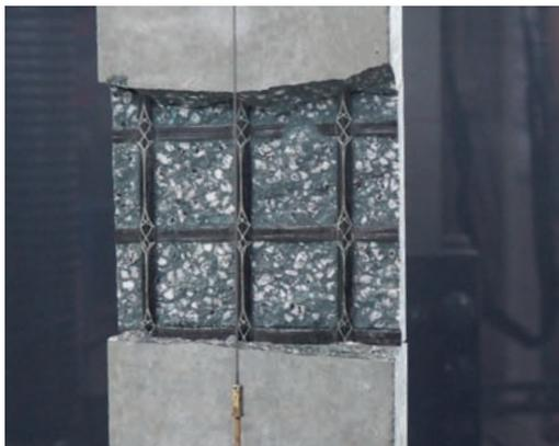
Ein Blick ins Innere: auch ohne Beton kann das Textil der Ermüdungsbelastung standhalten | A glimpse inside: the textile withstands fatigue loading even without concrete | Photo: Juliane Wagner
