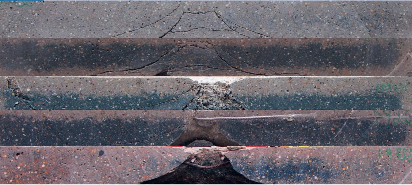
Stahlbetonplatten nach Impact mit Geschwindigkeiten zwischen 25 und 61 m/s | Steel reinforced concrete slabs after impact with velocities between 25 and 61 m/s | Photos: Marcus Hering
