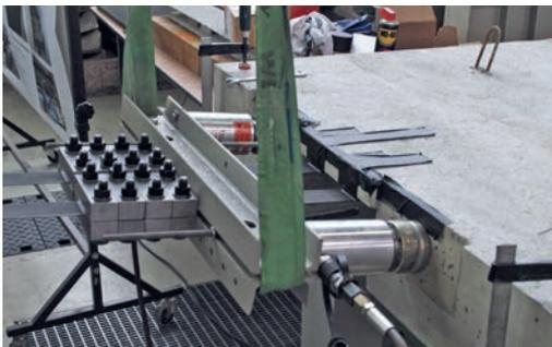
Vorspannvorgang mit temporären Ankerkörpern am Deckenelement | Pre-Stressing via the developed temporary anchorage | Photo: Oliver Steinbock
