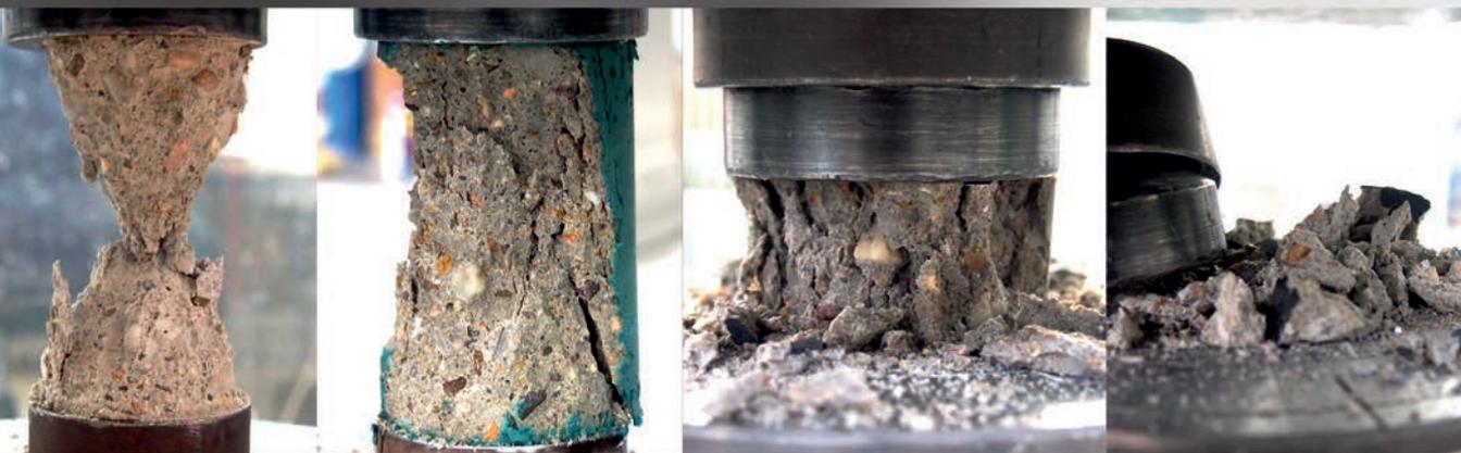
Versagen der Betonproben: links: trockene Proben; rechts: wassergesättigte Proben | Failure of the concrete specimens: left: dry specimens; right: water-saturated specimens | Photos: Oliver Mosig
