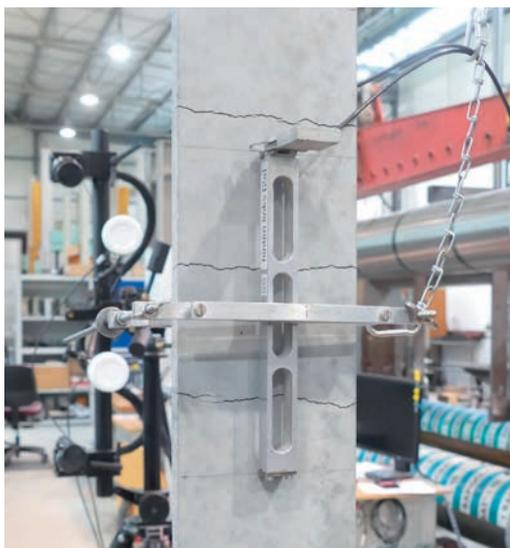
Tastversuch zur Überprüfung der gewählten Materialkombination | Preliminary test to prove the suitability of the defined materials | Photo: Alexander Schumann
