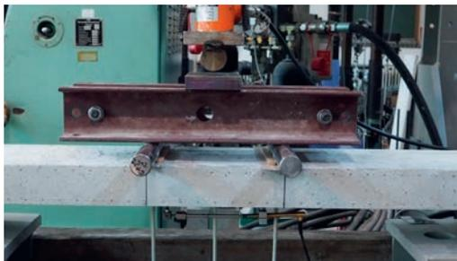
Biegeversuch eines Betonelements mit integrierten Funktionskörpern | *Bending test of a concrete element with integrated functional elements* | Photo: Philipp Riegelmann
