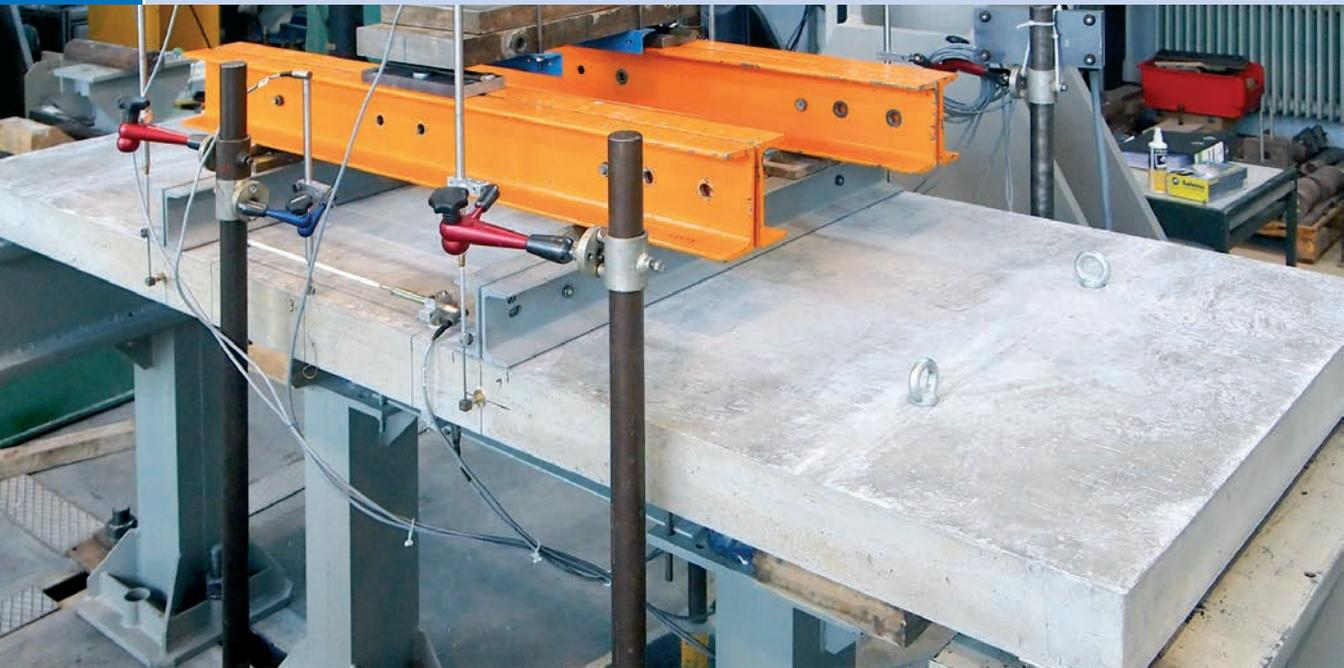
Großbauteilversuch zur Untersuchung der Endverankerung der Carbonbewehrung | Large-scale test to investigate the bond behaviour and end anchorage length of the carbon grid | Photo: Alexander Schumann
