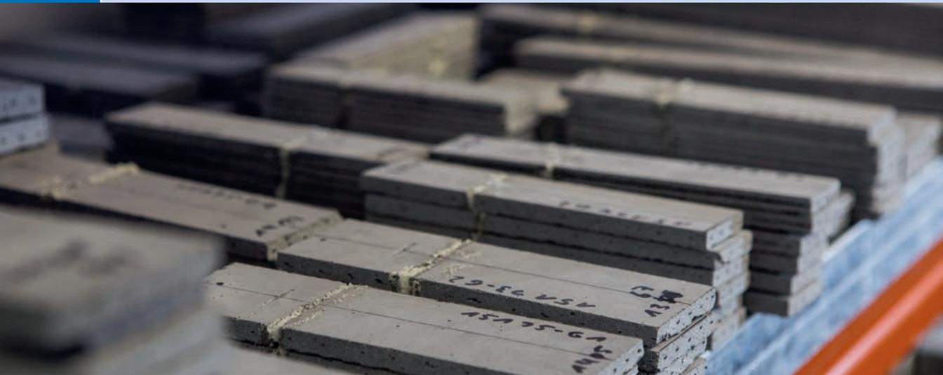
Lagerung von Verbundprobekörpern aus Carbonbeton unter kontrollierten Bedingungen in der Klimakammer | Storing of specimen under controlled conditions in a climate chamber | Photo: Thilo Schoch
