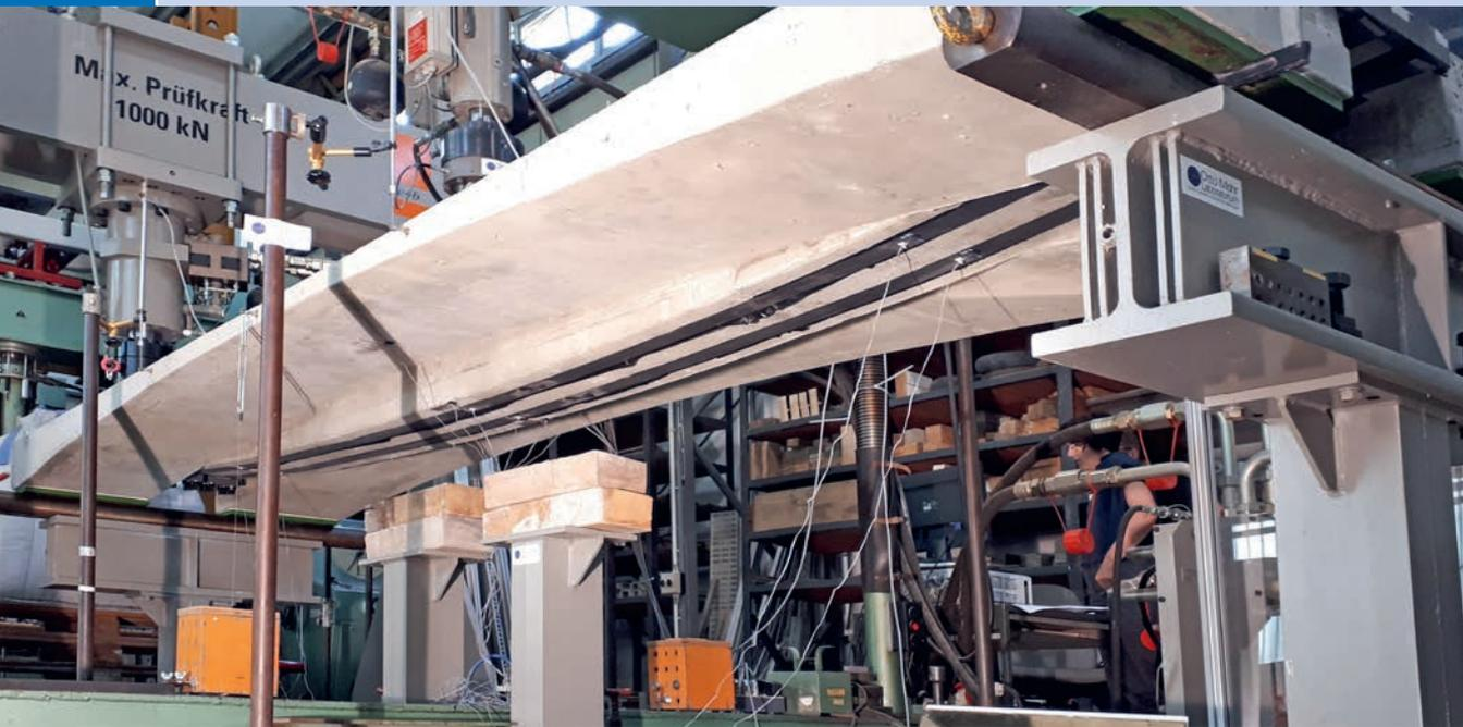
Untersicht auf vorgespanntes Deckenelement mit extern verlegten CFK-Lamellen | Bottom view of pre-stressed slab element with extern applied CFK-Lamellas | Photo: Oliver Steinbock
