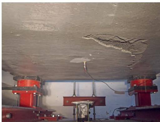
Unterseite einer verstärkten Stahlbetonplatte nach dem Versuch | Bottom side of a strengthened reinforced concrete plate after the experiment | Photo: Marcus Hering
