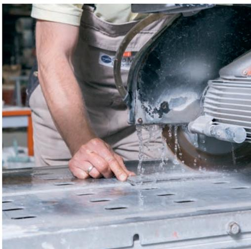
Versuchsvorbereitung: Sägen von Verbundprobekörpern zur späteren Bestimmung der Materialkennwerte | *Preparation of material tests: Cutting of specimen in order to identify the material properties of carbon reinforced concrete* | Photo: Jörg Singer
