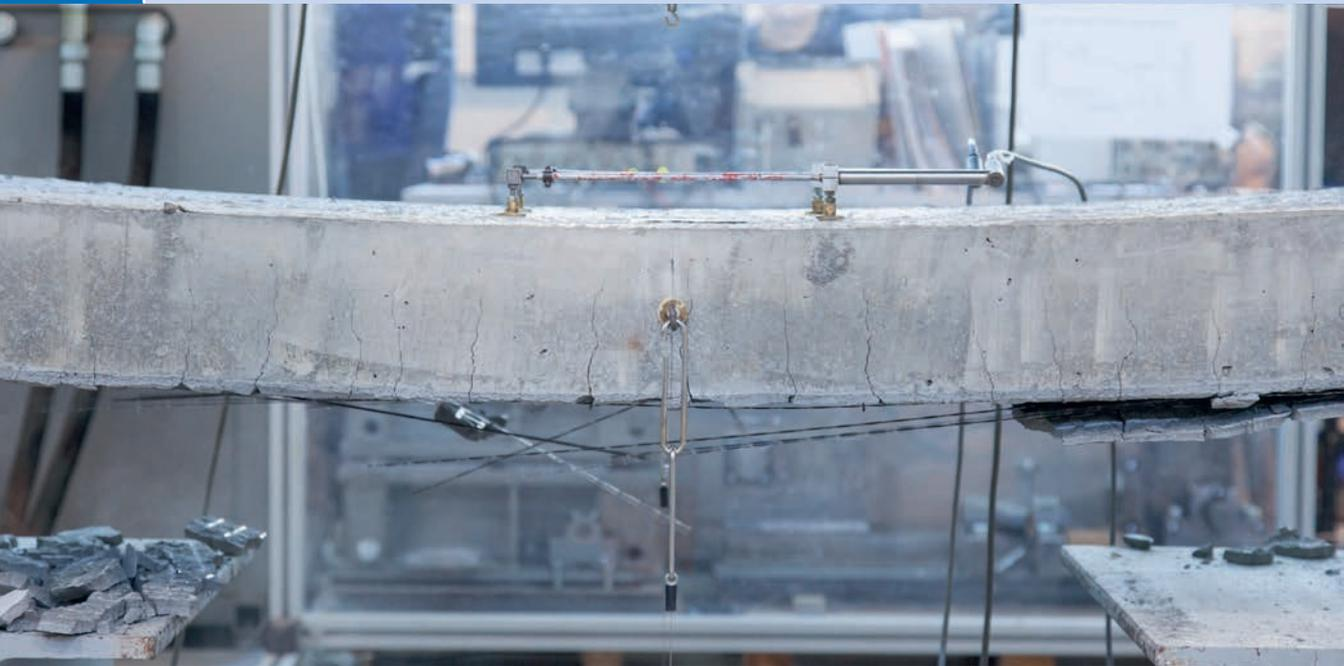
Mit Carbonbeton verstärkte Stahlbetonplatte nach Versagen | *Steel reinforced concrete slab strengthened with carbon reinforced concrete after failure* | Photo: Stefan Gröschel
