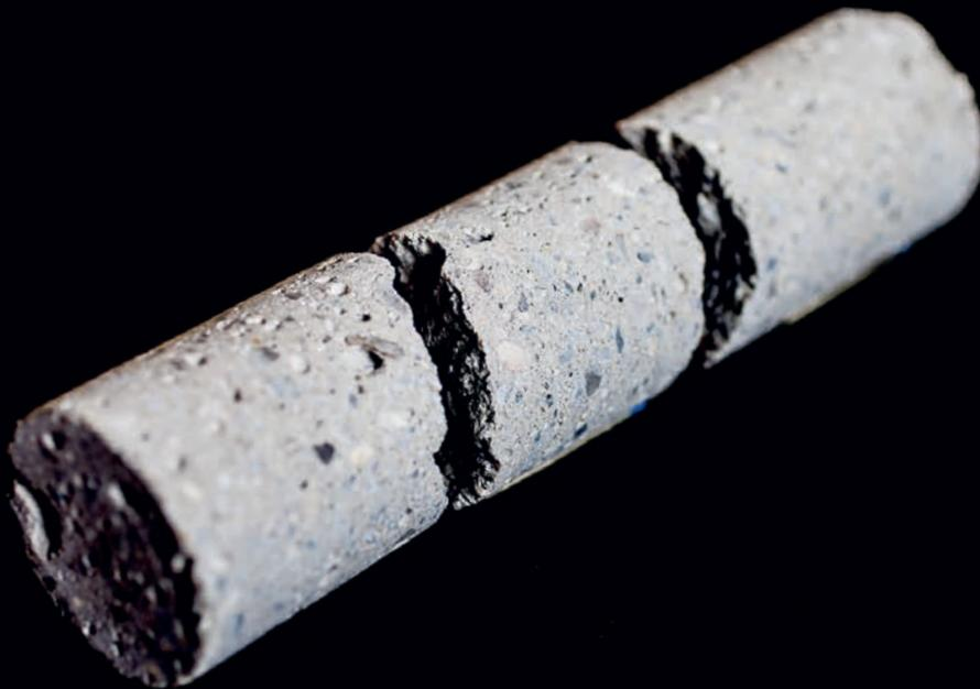
Festbetonprobekörper nach dem Spallationsversuch am Hopkinson-Bar | Concrete specimen after spallation test using the institute's Hopkinson pressure bar device | Photo: Ullrich van Stripriaan
