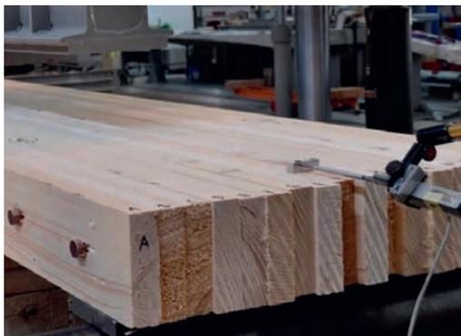
Schichtholz mit zusammengedrücktem Buchendübel | *Laminated timber with compressed beech dowel* | Photo: Stefan Würdig
