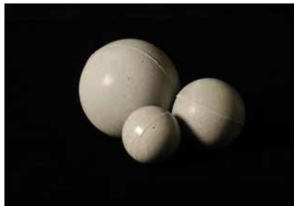
Bild 3 Betonhohlkugeln, hergestellt am ILEK. Die Wandstärke der Hohl- kugeln beträgt, je nach Erfordernis und ge- wünschter Robustheit, zwischen 1 und 4 mm, der Kugeldurchmesser beträgt bis zu 250 mm.
