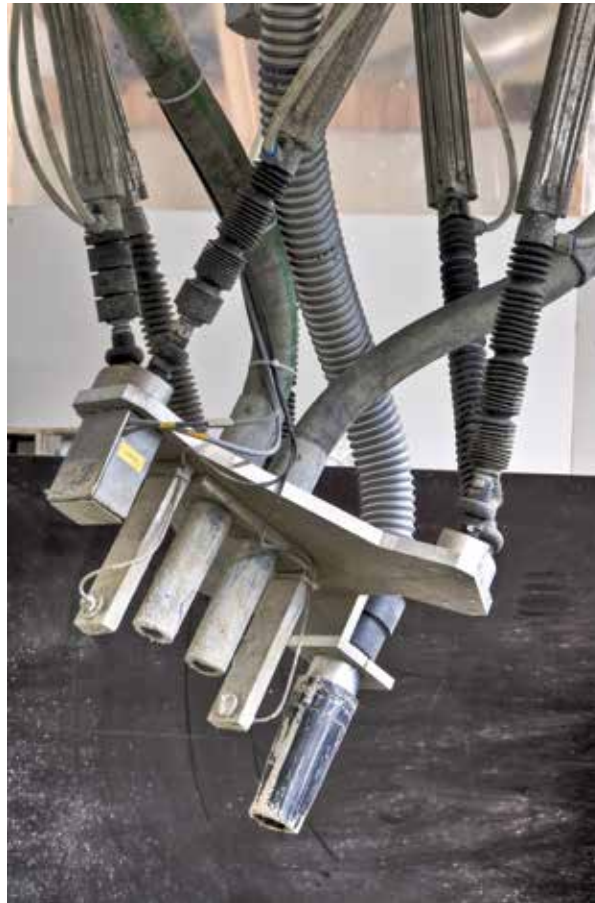
Bild 1 „Hexapod“: Zweidü- sensspritzverfahren zur Herstellung von Gradientenbetonen, entwickelt am ILEK in Kooperation mit ISYS (Foto: © ILEK, Gabriela Metzger)
