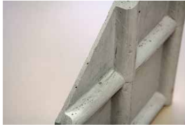
Bild 12 Schalungsmatrix aus gefrorenem Formsand und Muster mit rauten- artigen Verstärkungs- rippen aus hochfestem Feinkornbeton (Fotos: Patrick Forman)
