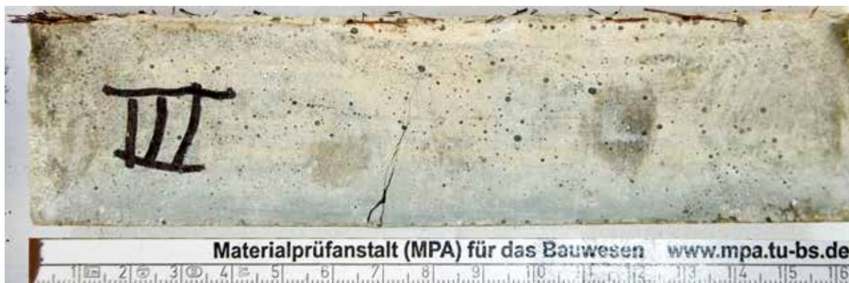
*Wassereindringen und Stofftransport in UHPFRC sind sehr gering. Nach 2 Tagen wurde das Prisma (40 × 40 × 160 mm) in einer NaCl-Lösung gelagert und nach 50 Tagen auf seine Biegezugfestigkeit geprüft. Die erzielte Biegezugfestigkeit ist vergleichbar mit der einer wassergelagerten Probe. Es ist nur Rost an freiliegenden Fasern zu sehen, jedoch keine Schädigung durch Korrosionsprodukte.*
