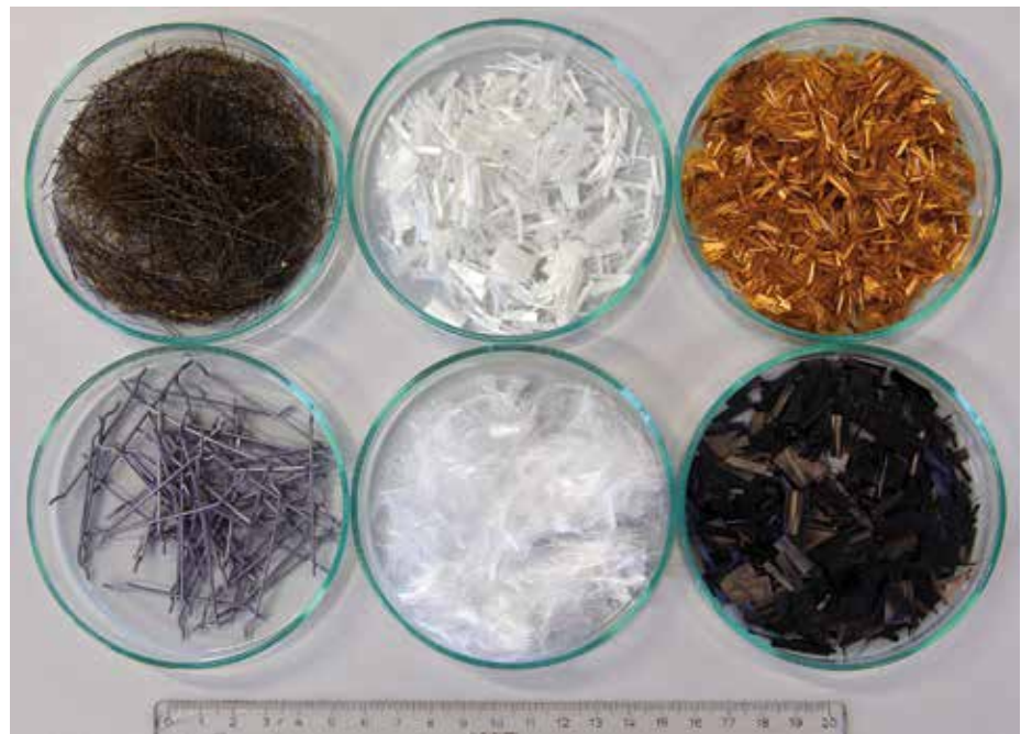
Bild 1 Repräsentative Fasermaterialien für zementgebundene Werkstoffe, von oben links im Uhrzeigersinn: Basalt, PVA, PBO, Carbon, HDPE, Stahl
