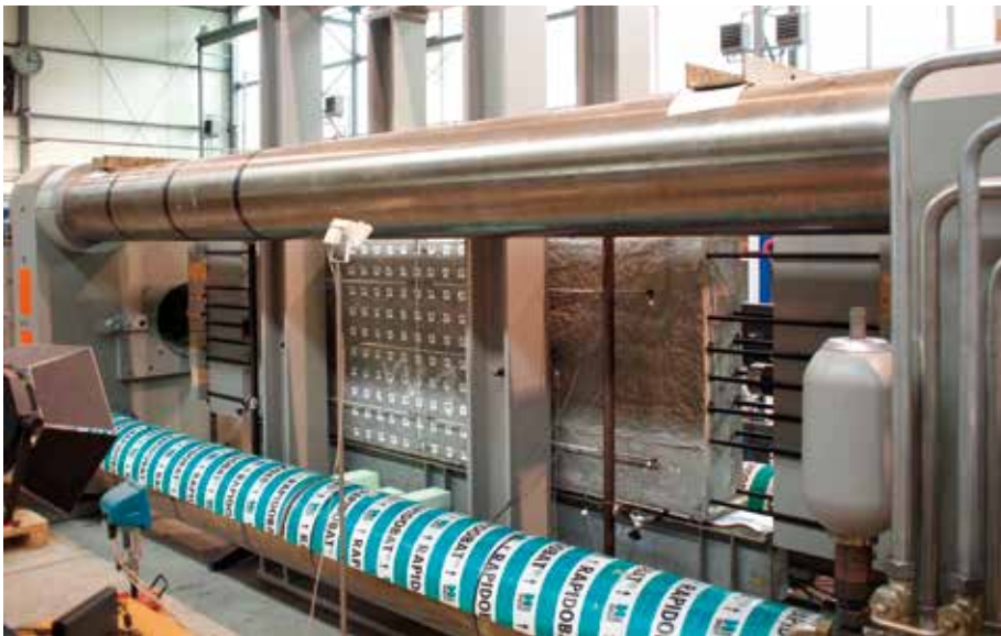
Bild 7 Versuchsstand für die großformatigen einaxialen Zugversuche im Otto-Mohr-Laboratorium (Foto: Eric Mündecke)
