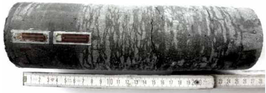
Bild 6 Multiple Rissbildung einer SHCC-Probe nach einem Zugversuch am Hopkinson-Bar [11]
