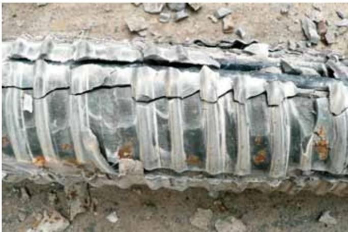
Punktuelle Rostspuren am Verpressmörtel an der Außenseite
