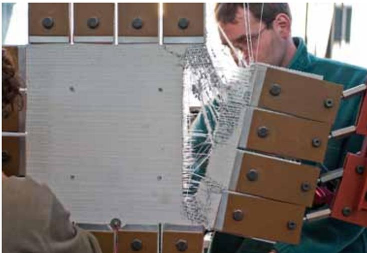
Versuchskörper für zweiachiale Zug-Zug-Versuche nach dem Versagen
