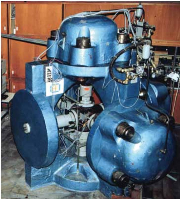
Triaxial-Prüfmaschine im Otto-Mohr-Laboratorium
