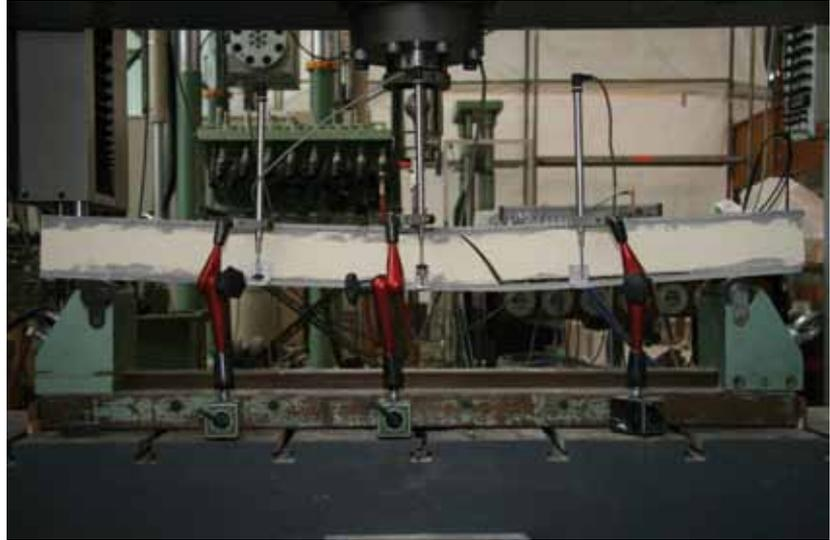
Versuchsaufbau 3-Punkt Biegung – Spannweite 100 cm
