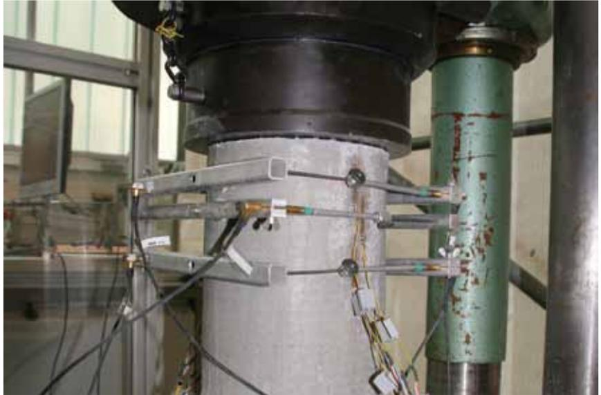
Probekörper in einer Druckprüfmaschine
