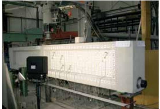
Biegeversuch an einem Spannbetonbalken
