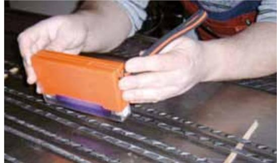
Rissdetektion mittels Fluoreszenzanalyse
