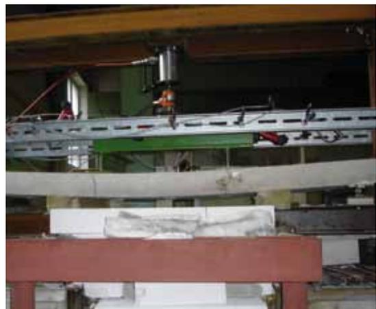
Brandversuch an einer verstärkten Stahlbetonplatte unter Biegung
