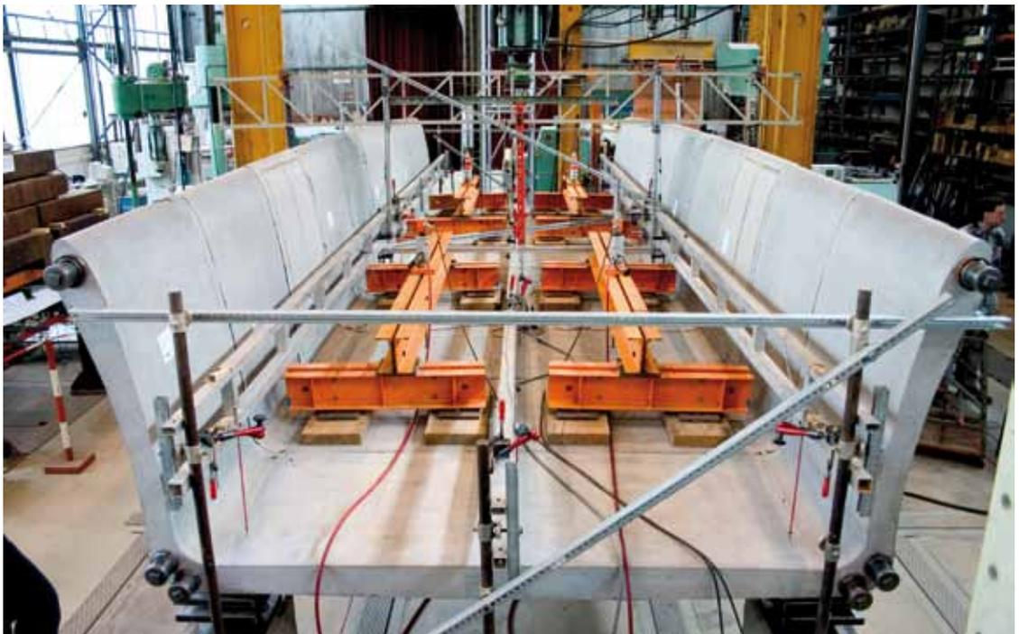
Zulassungsversuch an einem Prototyp einer Brücke aus Textilbeton
