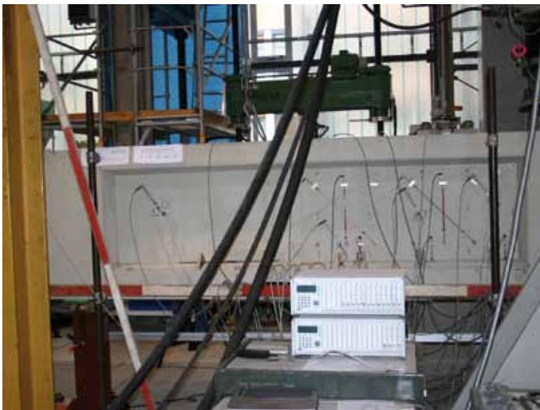
Verformungsmessung mit induktiven Wegaufnehmern
