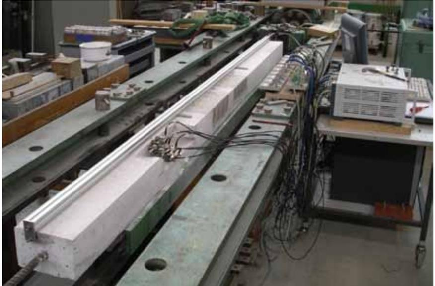
Bewehrter Dehnkörper in Testposition
