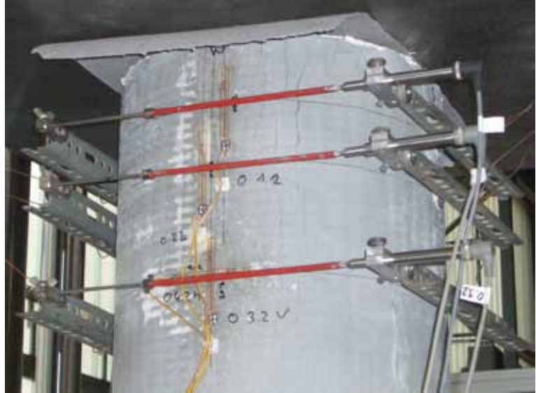
Verformungsmessung am Stützenkopf Deformation measurement at the prop head
