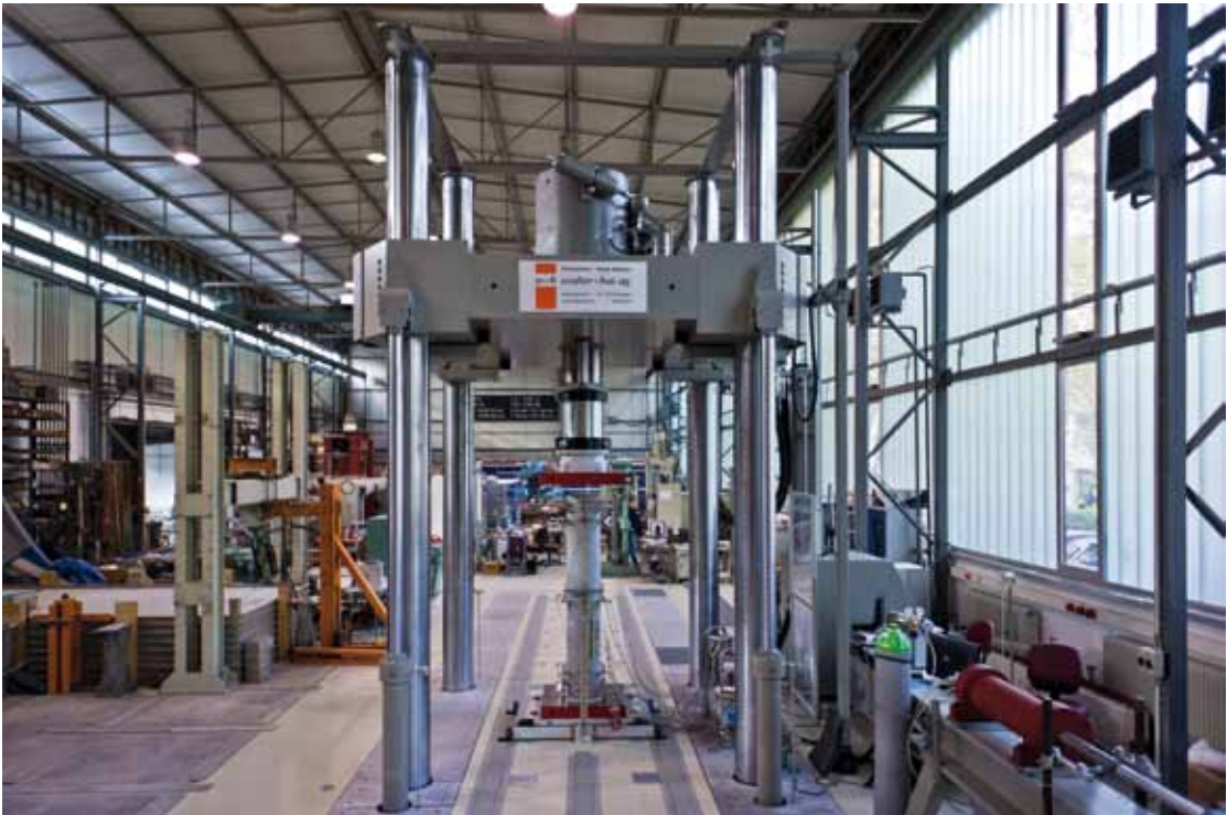
Stützenbelastung in der 10 MN Säulenprüfmaschine
