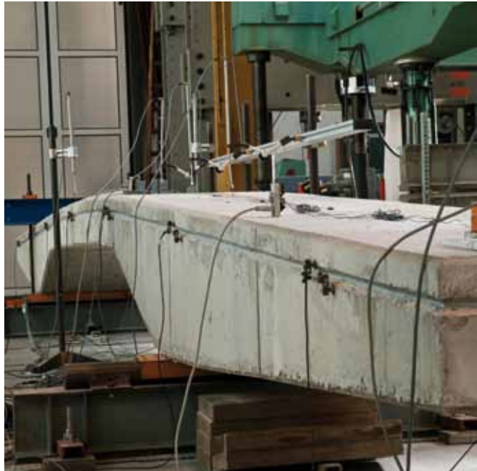
Träger mit Flüssigkunststoffdichtschicht bei Belastung auf dem Kragarm
