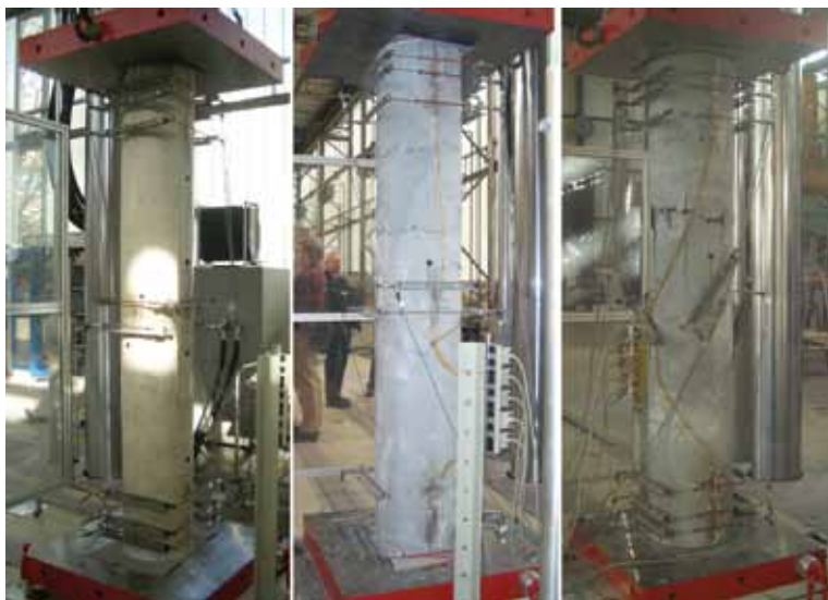
Versuche an unverstärkten und verstärkten Stützen Tests at un-reinforced and reinforced columns
