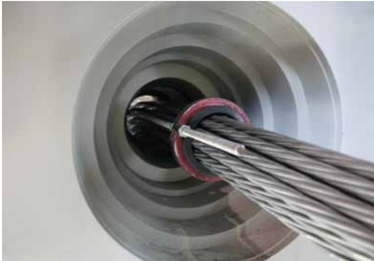
Einbau eines Litzen-Spanngliedes zur Prüfung
