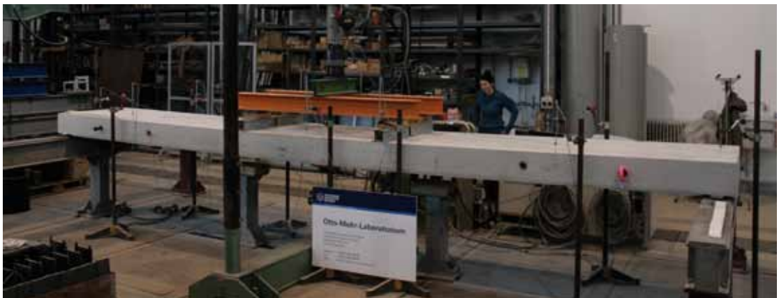
Verstärkte Stahlbetonplatte beim 4-Punkt-Biegeversuch Reinforced concrete slab in a 4-point bending test
