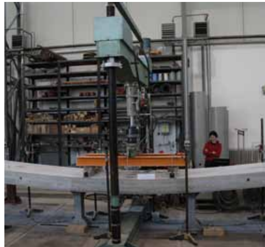
Textile Verstärkung: Große Verformung ohne Bruch
