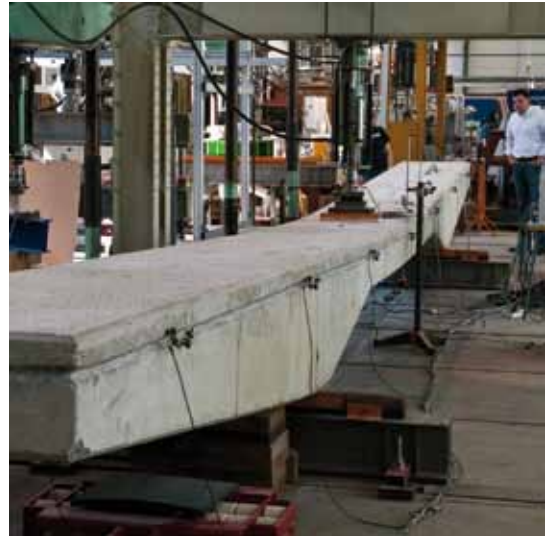
Großversuch an einem Träger mit Flüssigkunststoffdichtungsschicht, Belastung in Feldmitte
