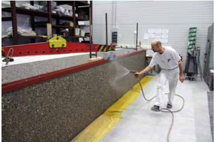
Aufbringen der textilen Verstärkungsschicht auf die Versuchsplatte
