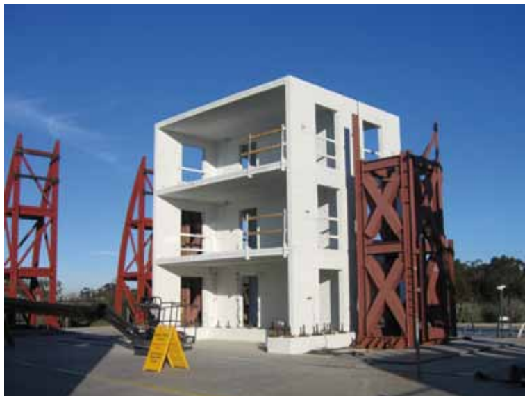
Einzigartige versuchstechnische Möglichkeiten der UCSD: Der große Rütteltisch Unique Testing facilities of UCSD: The big Shaking Table
