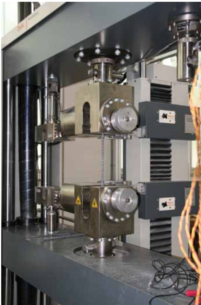
Spannstahlprobe im Zugversuch Prestressing bar during tension test
