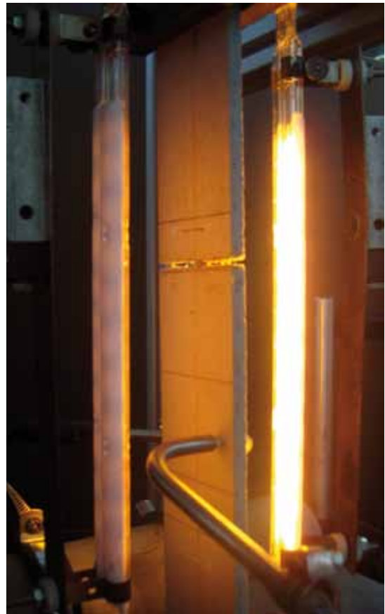
Textilauszugsversuche unter Temperaturbelastung Textile pull-out tests under temperature load
