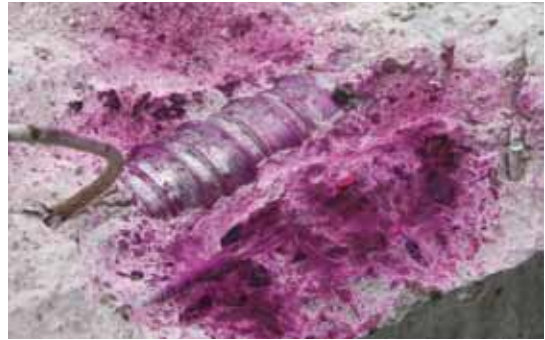
Bestimmung der Karbonisierungstiefe an einer Großprobe Determination of carbonation depth at a large sample
