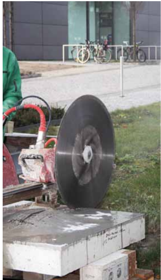
Nachträgliches Zersägen der impaktbeanspruchten Betonplatten Sawing of the damaged concrete slabs after impact test procedure
