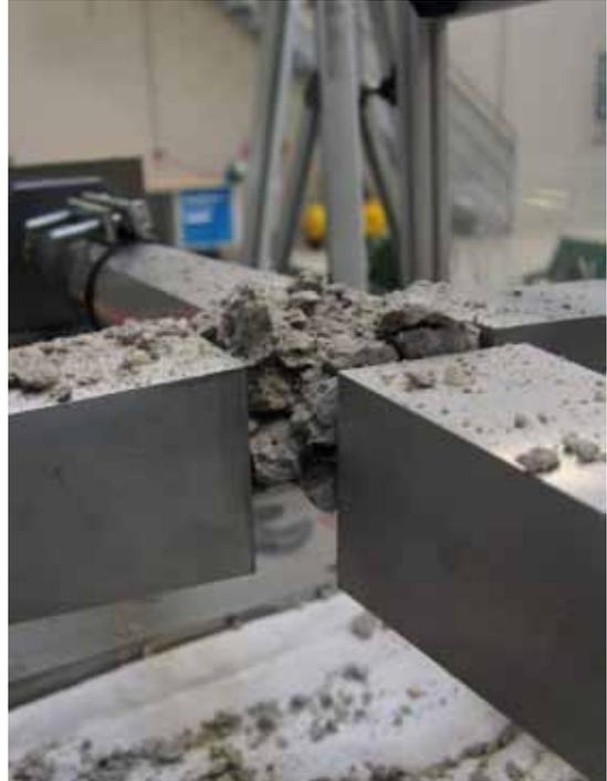
Zerstörte Betonprobe nach einem Versuch im zweiaxialen Split-Hopkinson-Bar
