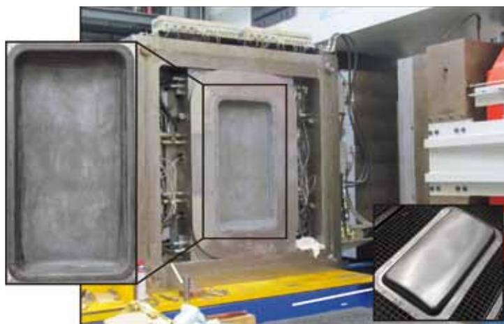
Großformatiges Betonwerkzeug in einer Hochdruckblechumformungspressen
