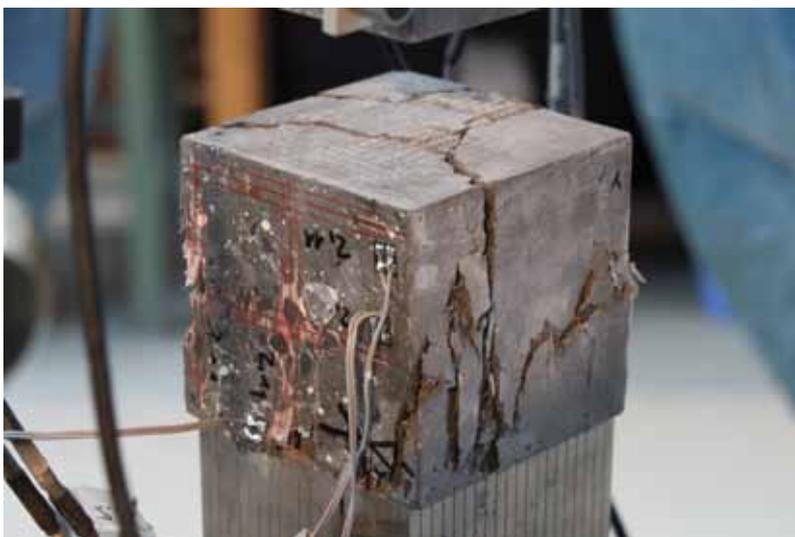
UHPC mit Fasern unter einaxialen Druck
