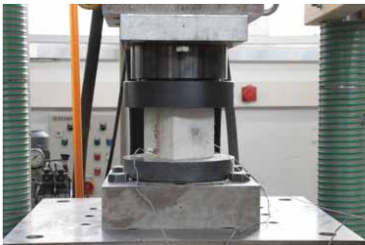
Prüfwürfel im Ermüdungsversuch
