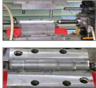
Innenhochdruckumformung mit Betonmatrizen
