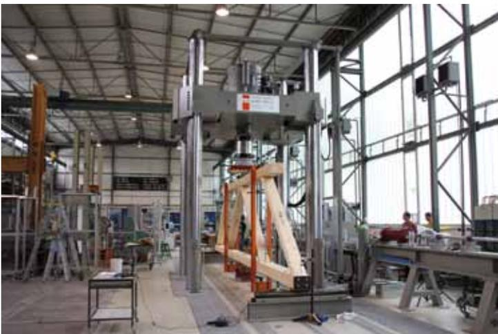
Versuchsträger mit 10 m Spannweite in der Prüfmaschine
