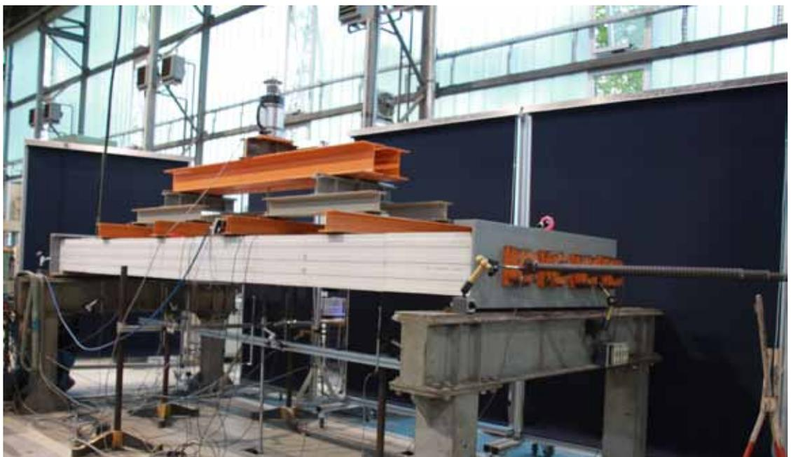
Flächenbelastung einer vorgespannten Decke aus Trockenmauerwerk Bild: Doreen Sonntag
