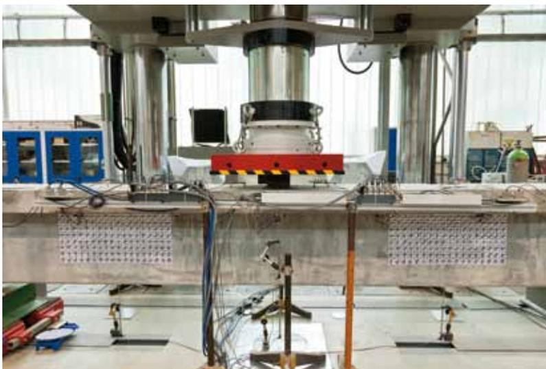
Großformatiger Plattenbalken im Test
