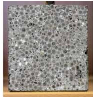
Kornverteilung in einem Betonwürfel
