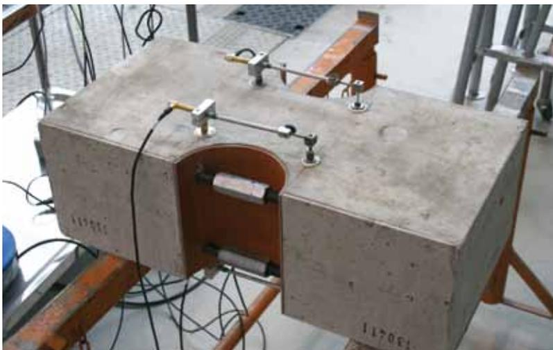
Probekörper bei der Erzeugung des Trennrisses
