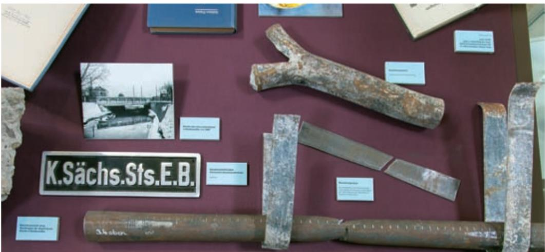
Bild 17: Geprüfte Rundstähle und Hennebique-Bügel der Brücke Dresden-Niedersedlitz als Exponate | Foto: Sven Hofmann
