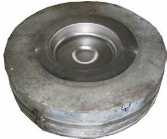
Betonwerkzeug mit einer Napfgeometrie mit Nebenformelement und umgeformtes Blech.
