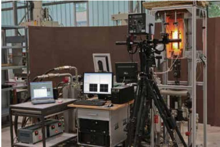
Hochtemperaturversuche an Dehnkörpern aus Textilbeton.
