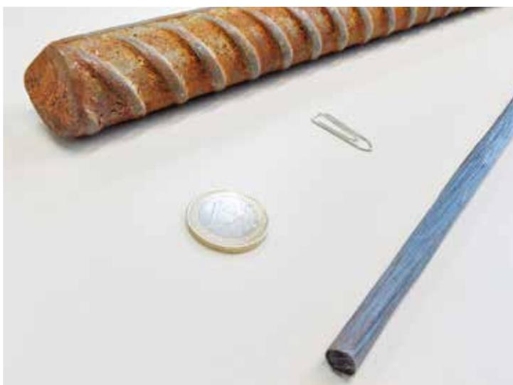
Bewehrung aus Stahl und Carbon mit äquivalenter Leistungsfähigkeit.
