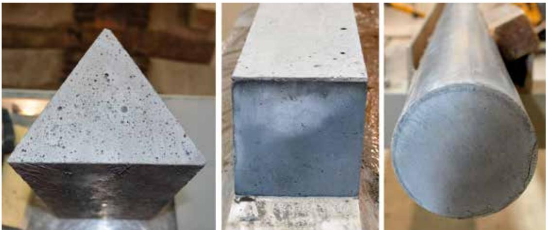
Verschiedene Stützenquerschnitte knickgefährdeter Stützen aus UHPC. *Slim UHPC columns with different cross-sections. Photos: Angela Schmidt*
