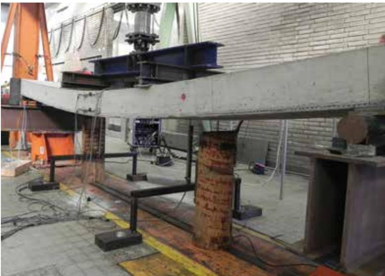
Versuchsstand für Biegeversuche in Innsbruck.
