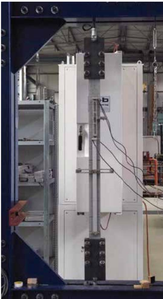
Einfacher Zugversuch im Rahmen der Zulassung.
