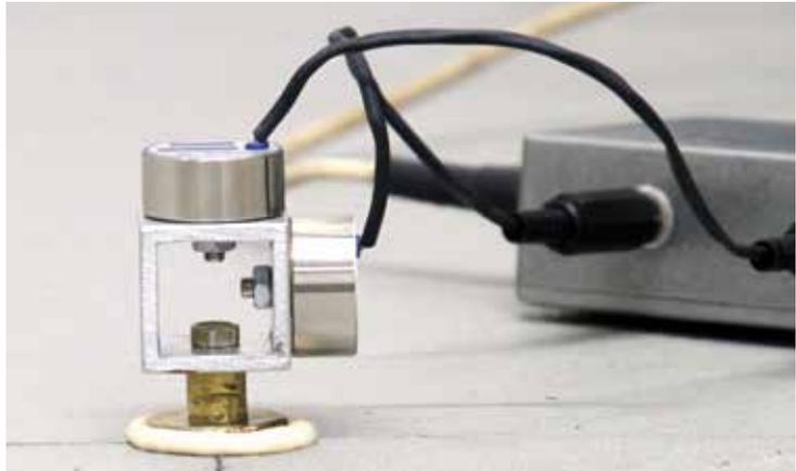
Auf dem Fußboden applizierter Beschleunigungssensor.
