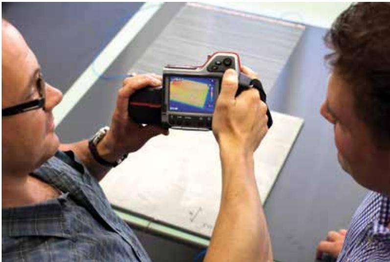
Aufnahme der Temperaturentwicklung mit der Wärmebildkamera.
