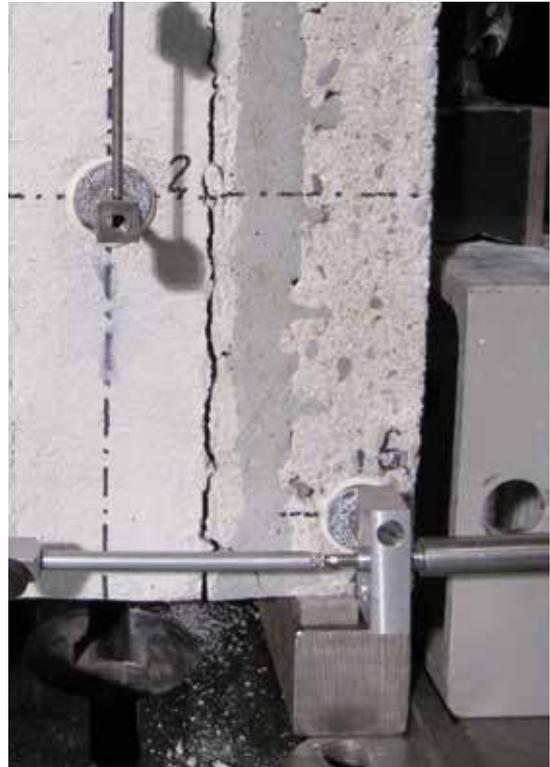
Kleinformatiger Prüfkörper zur Bestimmung der Fugenfestigkeit.
