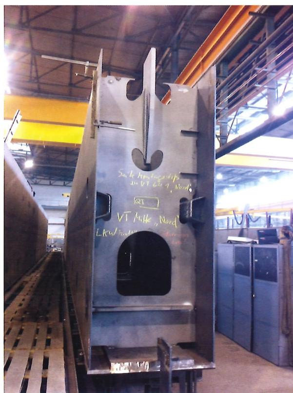
**Bild 10.8:** Werksfertigung Versteifungsträger mit Hängerschott
