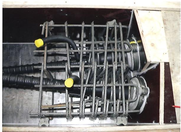
**Bild 13.3:** Spaltzugbewehrung des Versuchskörpers im Bereich der Ankerköpfe (Foto: TU Wien)
