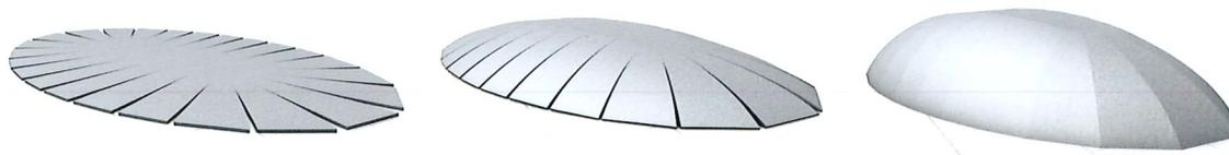
**Bild 13.10:** Transformation einer ebenen Betonplatte in eine doppelt gekrümmte Schale
