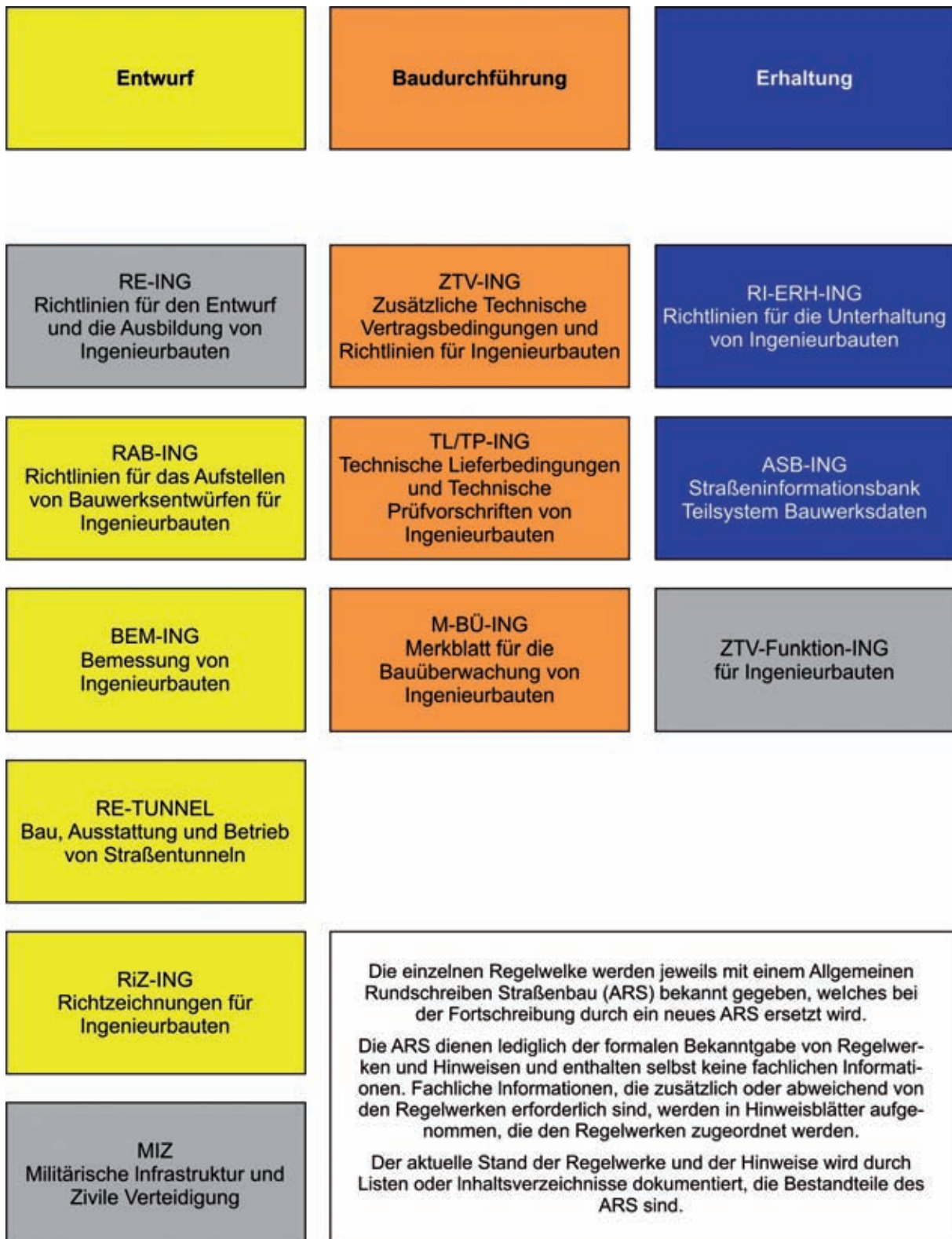
Bild 1: Übersicht der Regelwerke für den Brücken- und Ingenieurbau der Bundesfernstraßen, nach [6]
