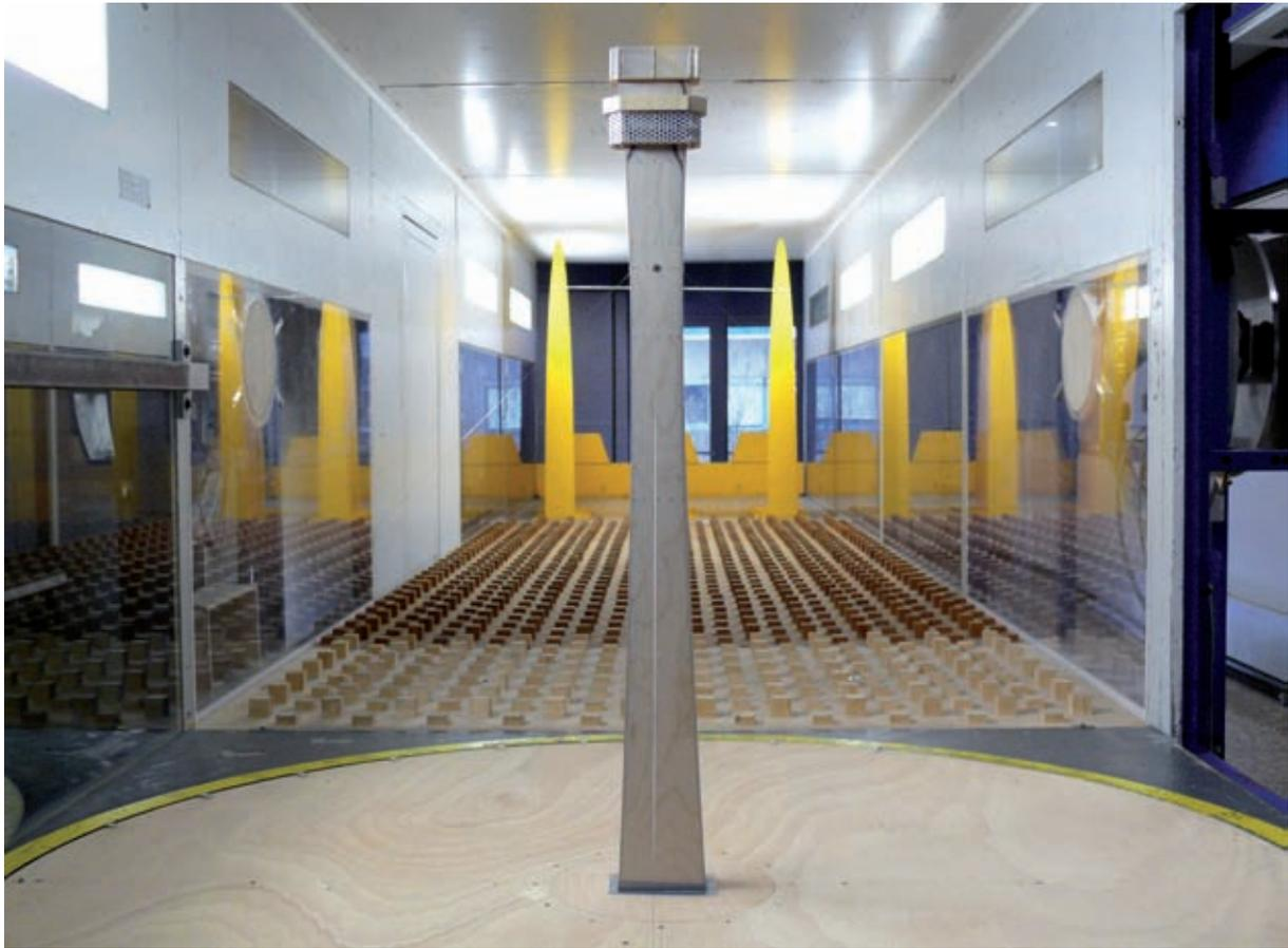
Bild 22: Pfeilermodell im Windkanal
