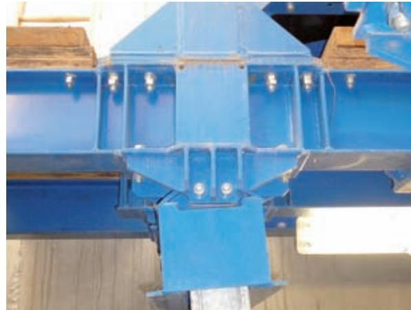
Bild 18: Rückansicht Drehlager unter Innenbühne
