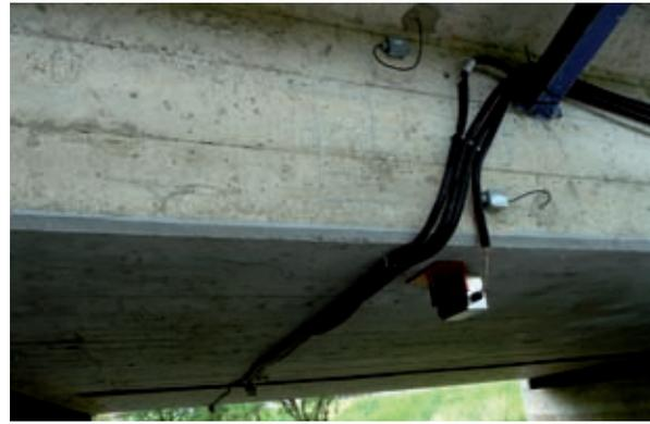
Bild 25: Permanentes Brückenmonitoring bei der Kocherbrücke Untergröningen
