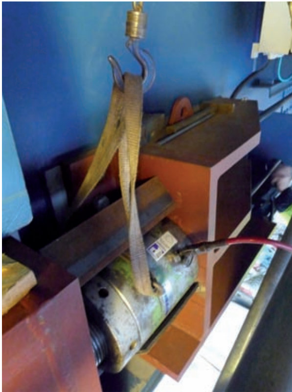
Bild 13: Vorspannkonstruktion mit Spann- und Festanker
