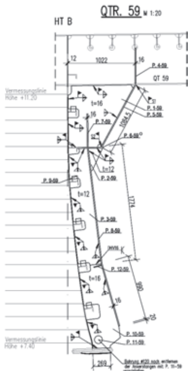
Bild 11: Werkstattzeichnung neue Quersteife Achse 59 (Zeichnung: Ingenieurbüro Grassl GmbH)
