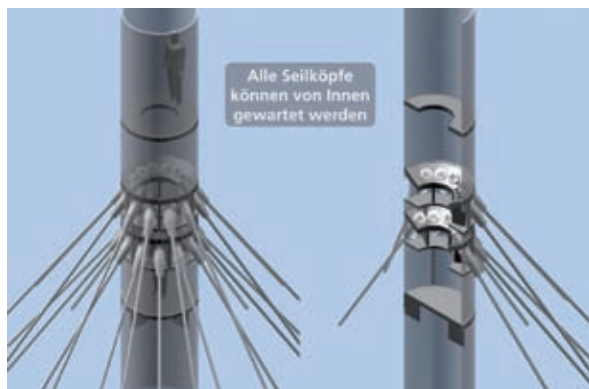
Bild 24: Seilbefestigung am Pylon und Inspektionsraum (© ipv Delft)
