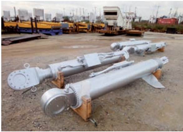
Bild 9: Hydraulikzylinder mit Drehlagern (Foto: Jan Lüdders)
