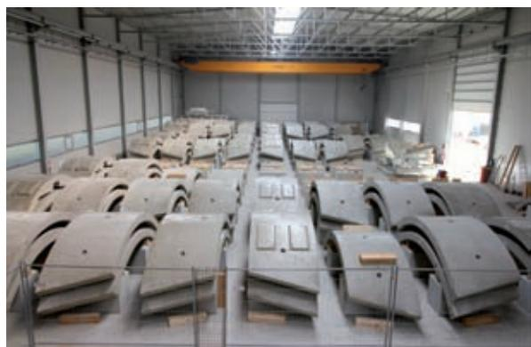
Bild 16: Tübings für den Tunnel des neuen Wasserkraftwerks in Pfunds/Österreich (Foto: Robert Zobel)
