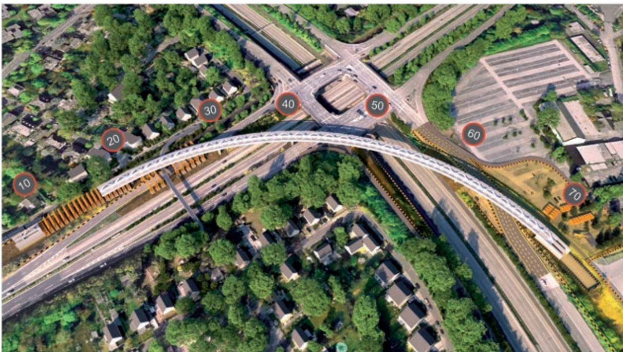
Bild 14 Vogelperspektive – Herstellung der Widerlager/Montage auf Traggerüsten
