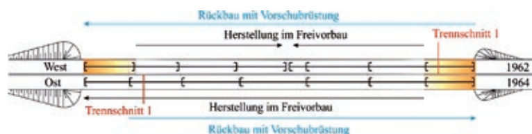
Bild 13 Herstellrichtung der Überbauten versus Rückbaurichtung mit Vorschubrüstung Zeichnung: Marx Krontal GmbH
