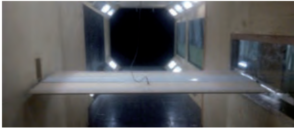
Fig. 13 Sectional model test in a wind channel Bild 13 Test an einem Modell eines Brückendeckauschnittes im Windkanal
