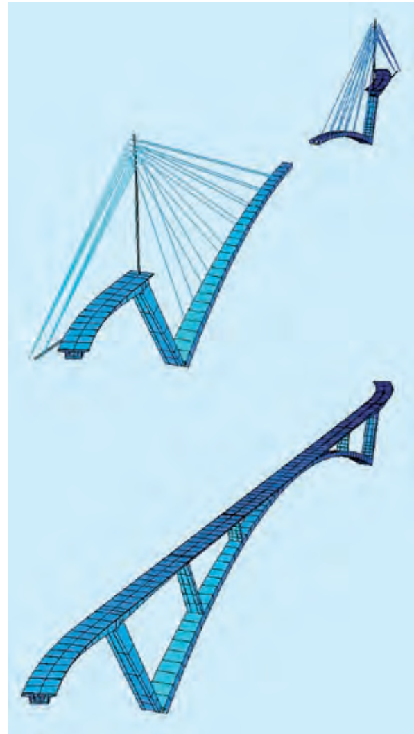
Bild 5 Statisches System im Bauzustand (oben) und im Endzustand (unten) Grafiken: © LAP
