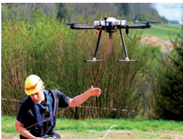
Bild 5 Seiltransport mit unbemanntem Flugsystem Foto: Juliane Kühnemund [22]
