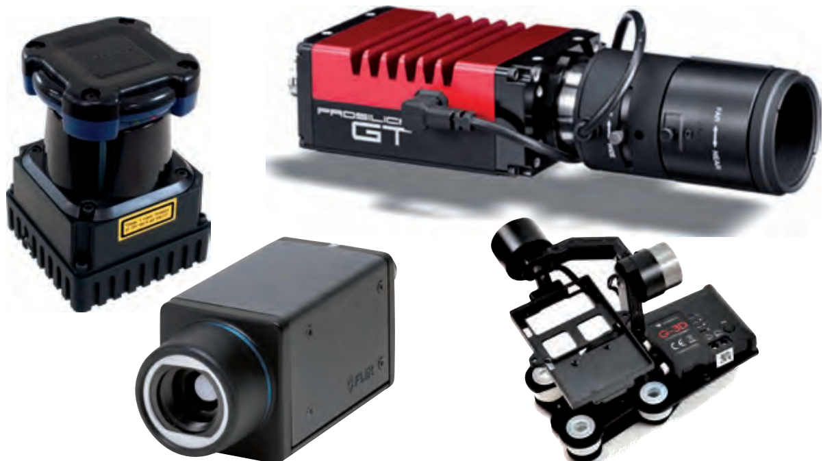
Bild 3 Spezifische Untersuchungsgeräte und Kamerahalterung; von oben links nach unten rechts: Laserscanner (hier: Hokuyo UTM-30LX-EW), RGB-Kamera (Prosilica GT3300C), Wärmebildkamera (FLIR A65), Kamerahalterung (Walkera G-3D Gimbal)
