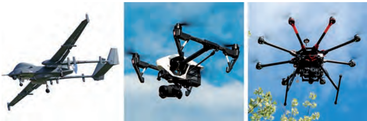
Bild 1 Unbemannte Flugsysteme – Unterscheidung nach der Auftriebserzeugung; von links nach rechts: Starrflügler „IAI Heron“, Drehflügler „DJI Inspire“ mit 4 Rotoren, Drehflügler „DJI Spreading Wings“ mit 8 Rotoren Fotos: links, Mitte und rechts [4]
