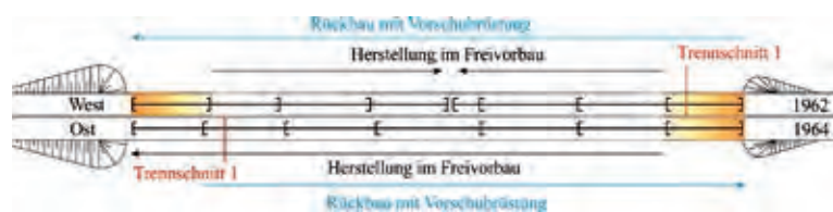
Bild 13 Herstellrichtung der Überbauten versus Rückbau mit Vorschubrüstung Zeichnung: Marx Krontal GmbH
