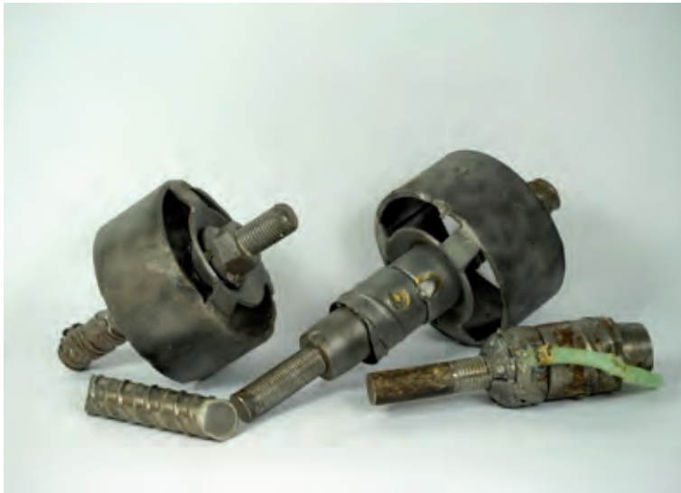
Bild 12 Ausgebaute Spannglieder mit Verankerungskörpern, Spaltzugring und Koppelmuffen Foto: Marx Krontal GmbH
