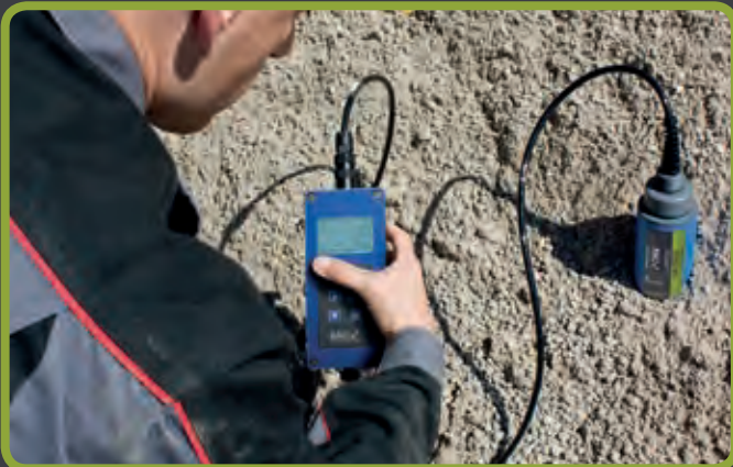
HD2 – das mobile Feuchtemessgerät für Sand, Kies und Splitt
