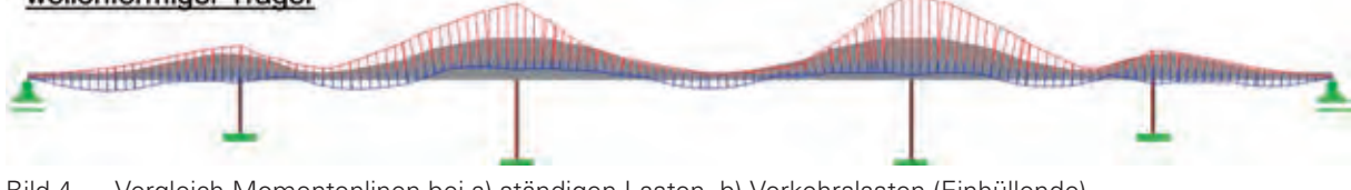
Bild 4 Vergleich Momentenlinien bei a) ständigen Lasten, b) Verkehrslasten (Einhüllende)
