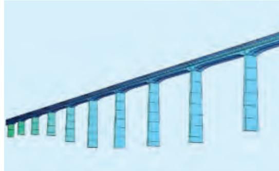
**Bauherr:** DB Netz AG **Bauart:** Mehrfeldrige semi-integrale Spannbetonbrücke
