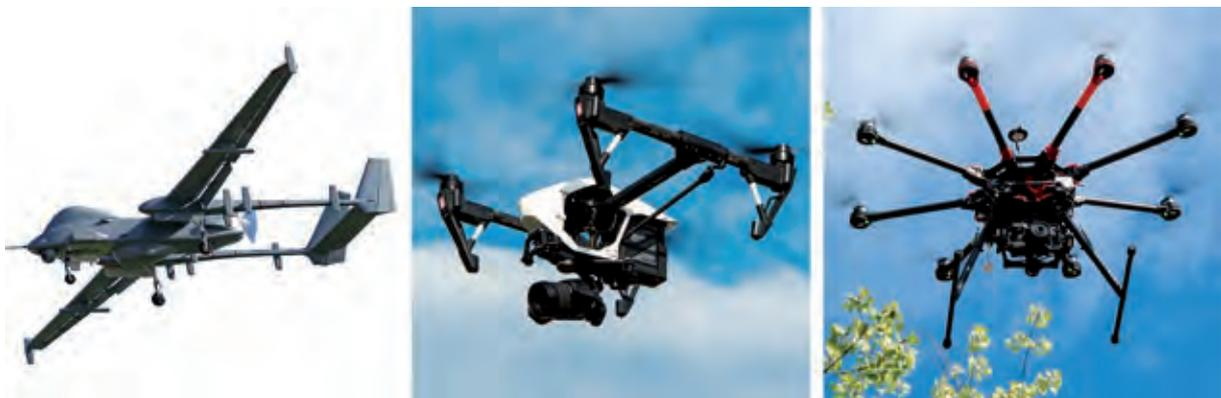
Bild 1 Unbemannte Flugsysteme – Unterscheidung nach der Auftriebserzeugung; von links nach rechts: Starrflügler „IAI Heron“, Drehflügler „DJI Inspire“ mit 4 Rotoren, Drehflügler „DJI Spreading Wings“ mit 8 Rotoren
