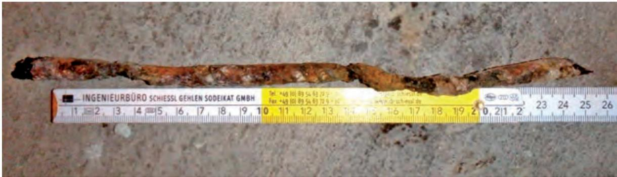
Bild 7 Aktive Bewehrungskorrosion in den Notgehwegen der Tunnelbauwerke Eching und Etterschlag
