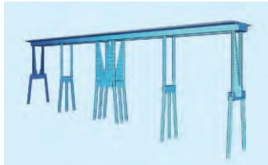
**Bauherr:** DB Netz AG **Bauart:** Semi-integrale Brücke mit Spannbetonplattenbalken **Entwurf- und Ausführungsplanung:** schlaich bergemann und partner **Zusammenarbeit:** SSF Ingenieure, Berlin
