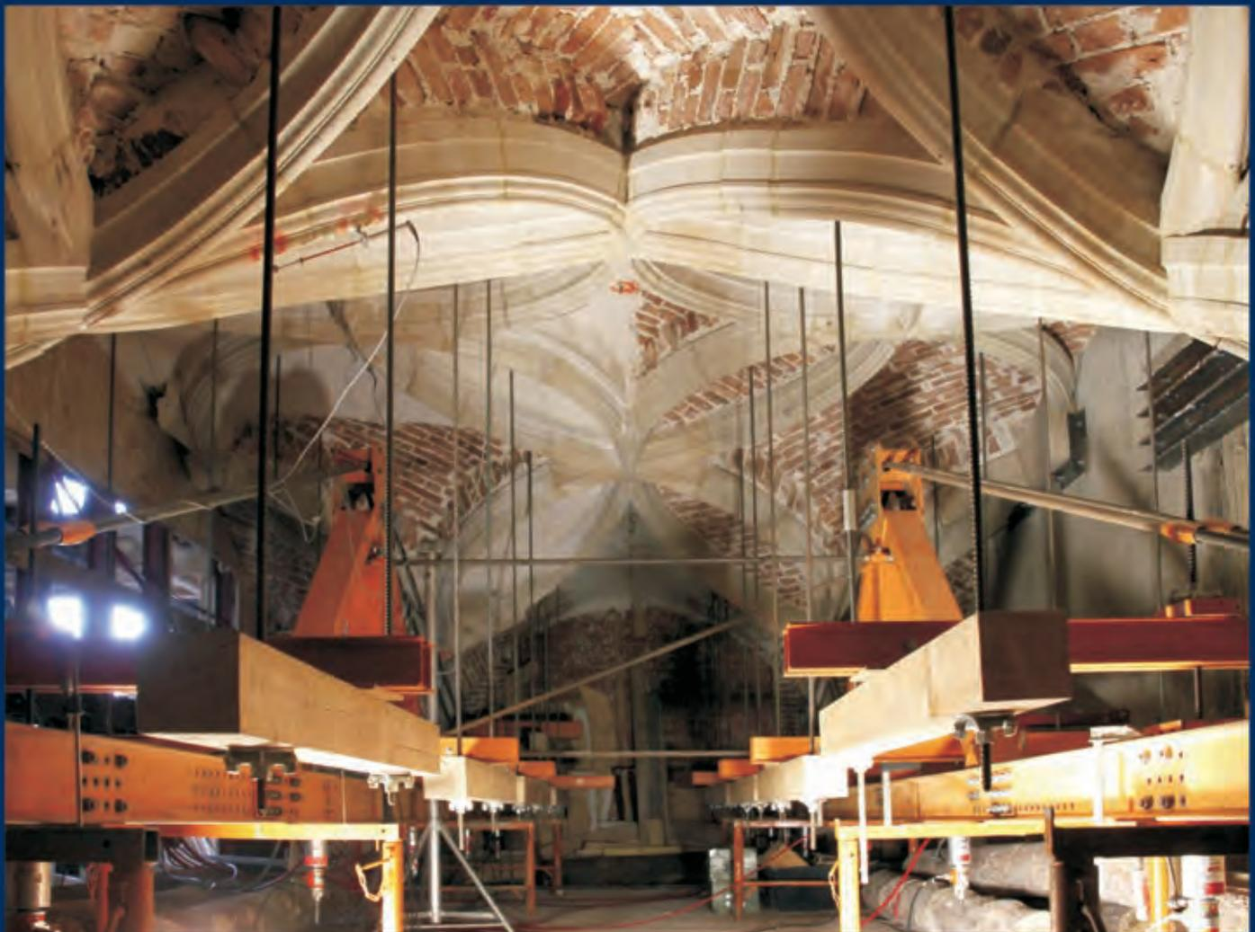
Belastungstest am Probejoch des Schlingrippengewölbes der Schützkapelle des
