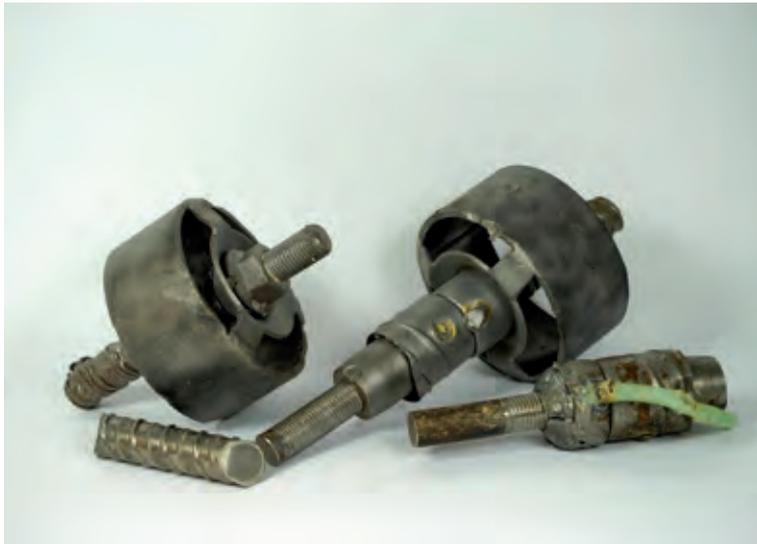
Bild 12 Ausgebaute Spannglieder mit Verankerungskörpern, Spaltzugring und Koppelmuffen Foto: Marx Krontal GmbH
