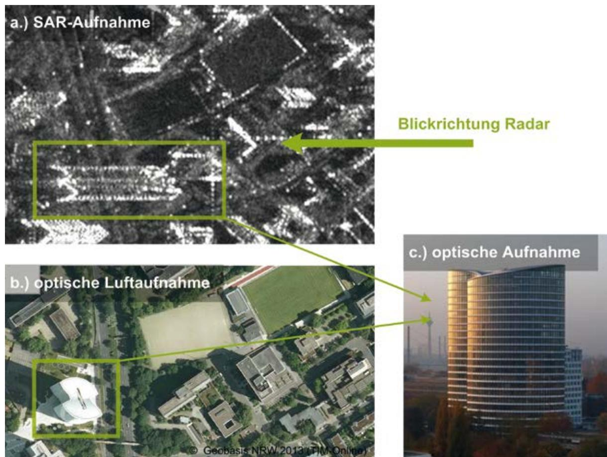
Bild 6 Vergleich von Radarbild (SAR-Aufnahme) und optischen Aufnahmen für einen Hochbau
