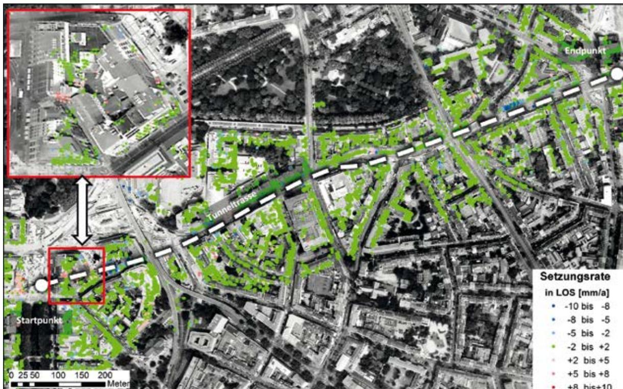
Bild 8 Farbliche Visualisierung punktwieser Setzungsmessungen an 16.000 Einzelpunkten
