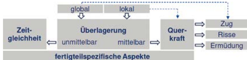
Bild 13 Überblick zum Zusammenwirken globaler und lokaler Beanspruchungen Grafik: aus [18]
