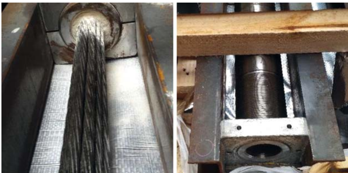
Bild 5 Verankerung des neu entwickelten Spanngliedes der DYWIDAG-Systems International (DSI) Fotos: Johannes Berger
