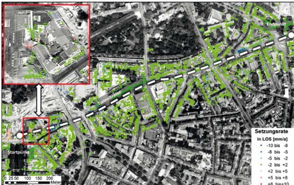
Bild 8 Farbliche Visualisierung punktwieser Setzungsmessungen an 16.000 Einzelpunkten Grafik: aus [15]
