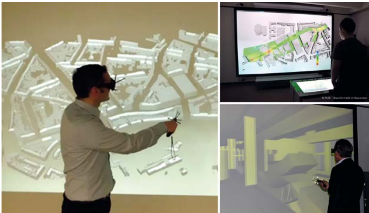
Bild 10 Aufnahmen aus dem Virtual-Reality-Labor (VR-Lab) an der Ruhr-Universität Bochum, 3D-Citymodell (links), farbliche Hinterlegung von Setzungen (rechts oben) und Positionierung von Tübbings in der Tunnelbohrmaschine (rechts unten) Grafik: aus [16]
