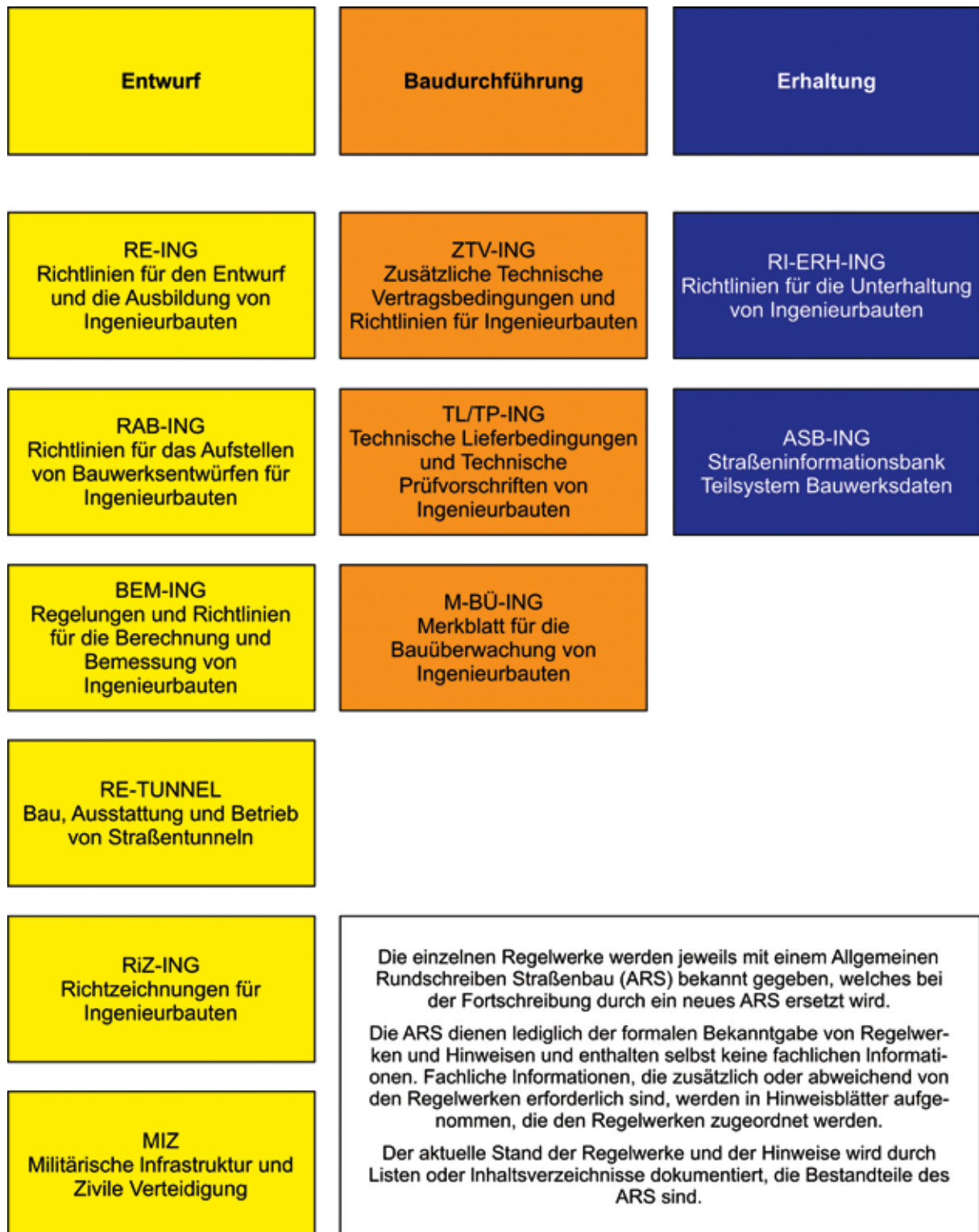
Bild 1 Regelwerk des Bundes für den konstruktiven Ingenieurbau
