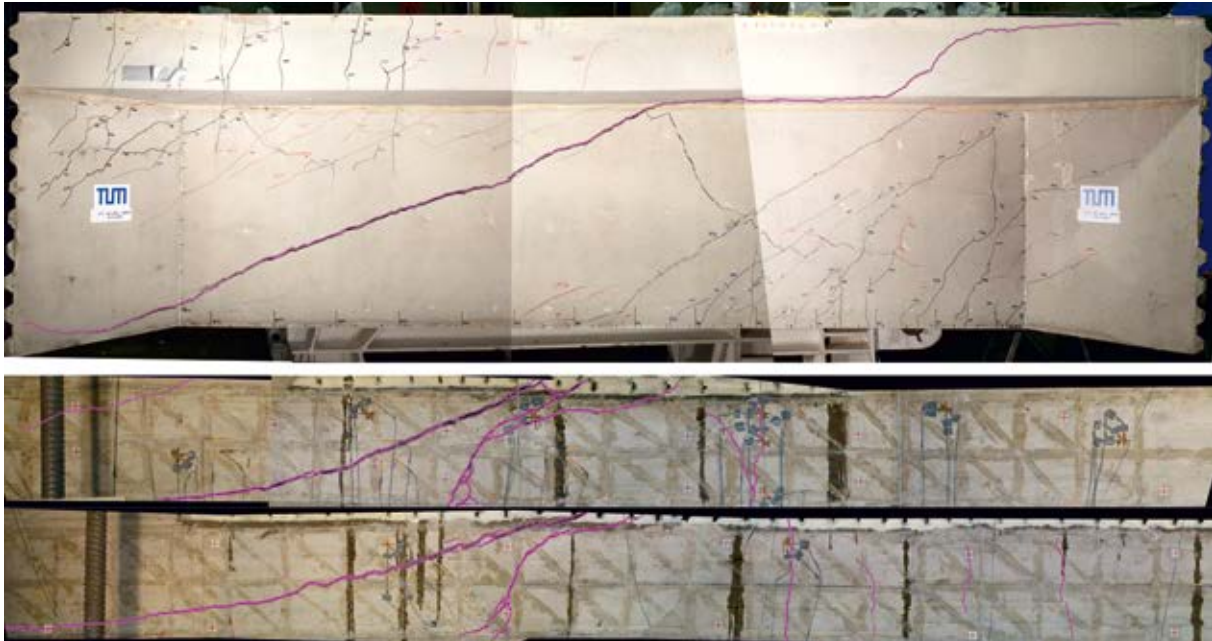
Bild 15 Vergleich der Rissbilder des ersten Substrukturversuchs (12/2018) zur Abbildung der In-situ-Versuche (oben) und der Rissbilder des Mittelsteiges der Brücke Hammelburg (unten, Versuch 3, Randfeld BA 1, Süd- und Nordansicht)
