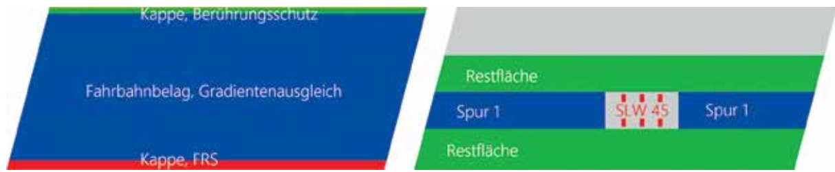
Bild 6 Ausbaulasten (links) und maßgebende Verkehrslaststellung (rechts)
