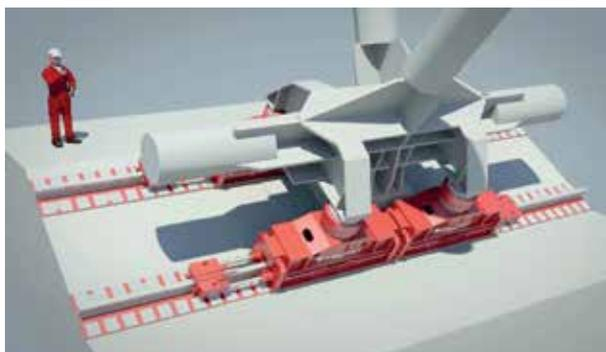
Bild 8 Konstruktionszeichnungen der Verschubeinheit
