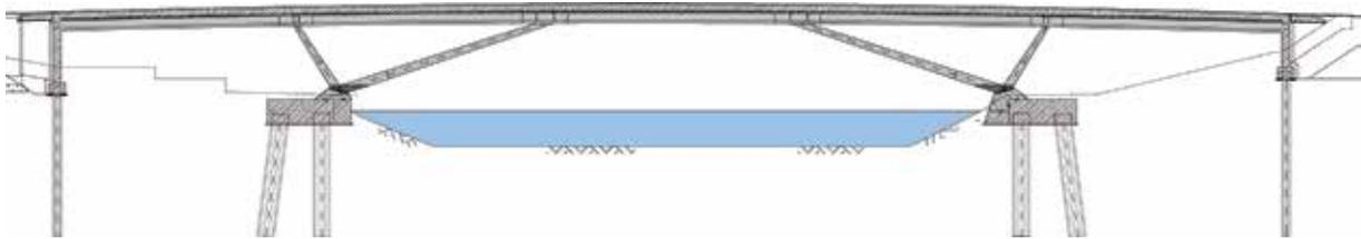
Bild 19 Bleichinselbrücke Heilbronn – Längsschnitt
