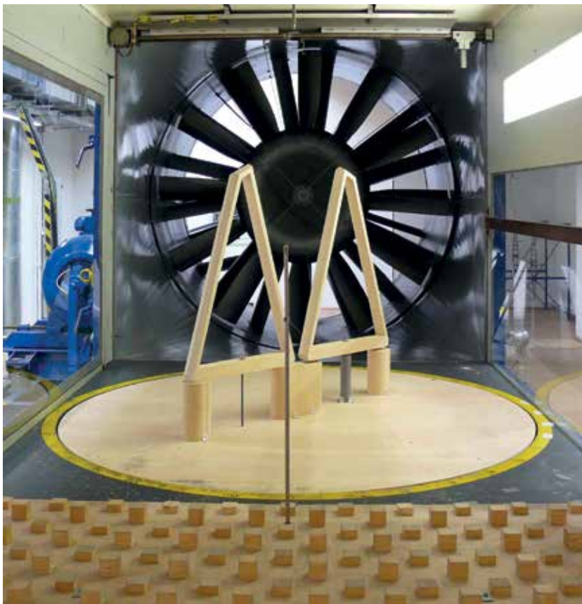
Bild 8 Aerodynamische Modellversuche im Windkanal – Pylone © Ingenieurgesellschaft Niemann & Partner GbR im Auftrag der Ingenieurbüro GRASSL GmbH
