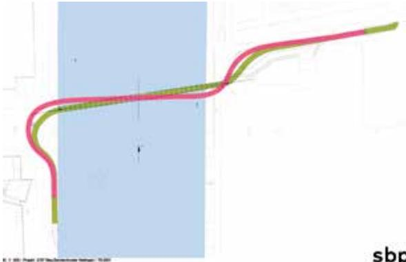
Bild 3 Steg Mettingen – Grundrissverformung bei Temperaturerwärmung © schlaich bergemann partner
