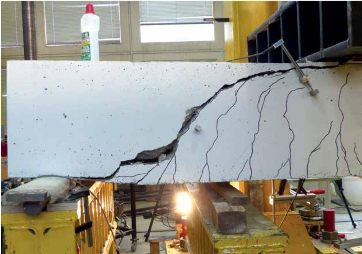
Bild 13 Versuchskörper im Bruchzustand
