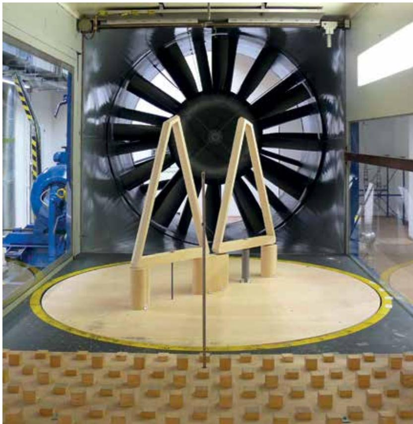
Bild 8 Aerodynamische Modellversuche im Windkanal – Pylone
