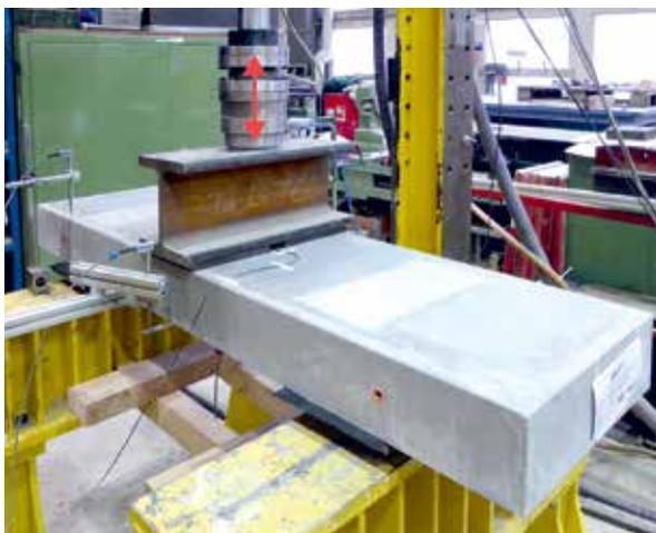
Bild 14 Ermüdungsversuch
