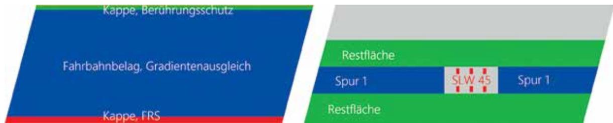
Bild 6 Ausbaulasten (links) und maßgebende Verkehrslaststellung (rechts)
