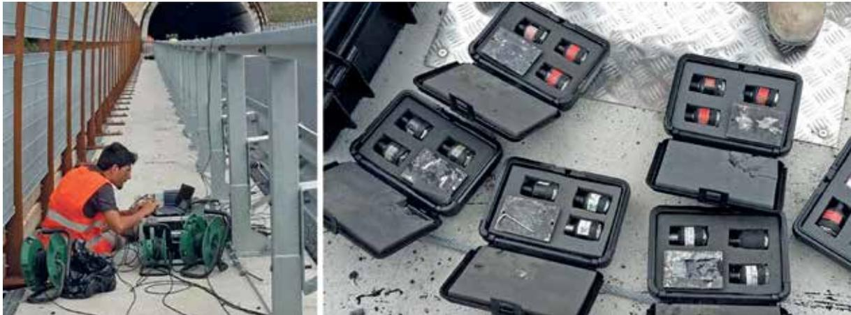
Bild 1 Tägliche Erfassung mit seismischen IEPE-Sensoren mit ständiger Anwesenheit des Bedieners
