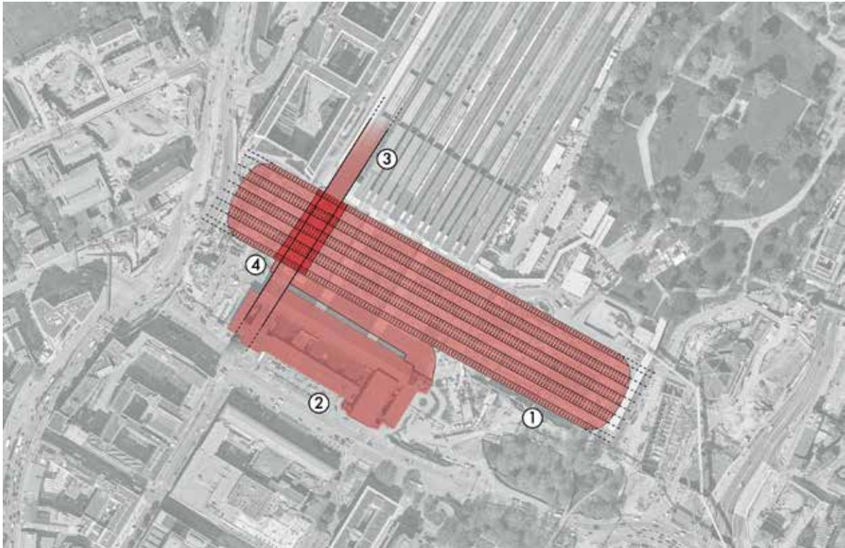
Bild 2 Übersichtsplan Stuttgarter Hauptbahnhof; 1) zeigt die neue Bahnsteighalle, 2) den Bonatzbau; 3) verweist auf den bestehenden S-Bahn-Tunnel, 4) auf die neue S-Bahn-Querung
