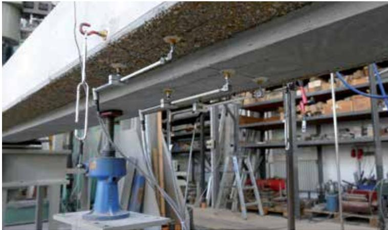
Bild 8 Prüfung der Großbauteile mit sechs Lagen Carbongelege
