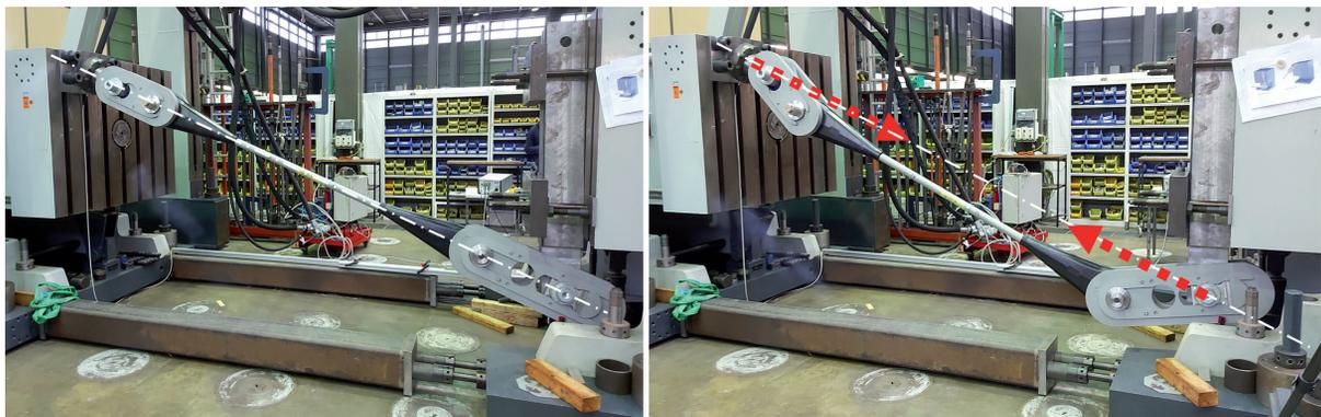
Bild 16 Hänger-Entlastungsversuch im Vorfeld zum Verschieben des Netzwerkbogens der Oderbrücke bei Küstrin
