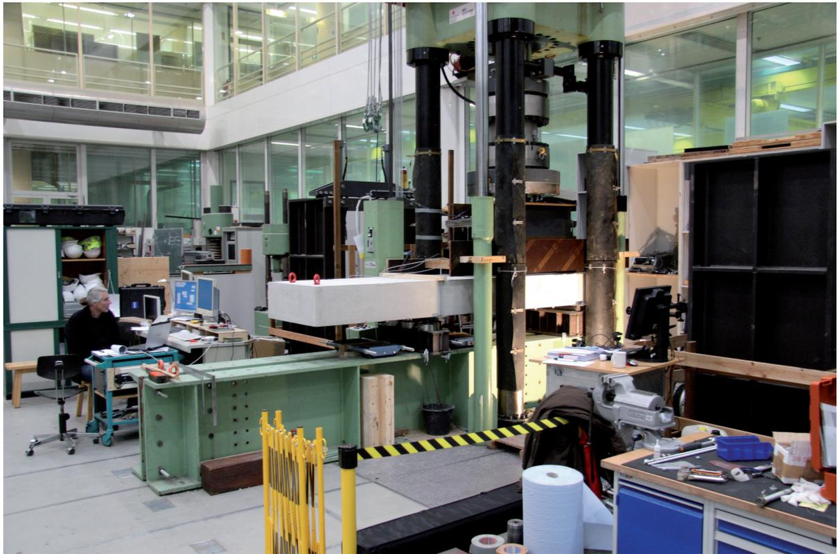
Bild 4 Versuchsaufbau der durchgeführten Querkraftversuche an Plattenstreifen an der Universität der Bundeswehr in München
