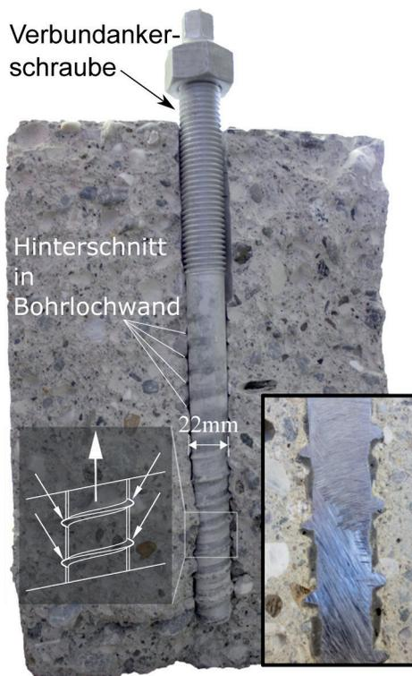
Bild 3 Tragwirkung der Verbundankerschrauben als kombiniertes Tragverhalten auf der Basis von Hinterschnitt über das Betonschneidegewinde und Verbund über den zusätzlich eingebrachten Verbundmörtel
