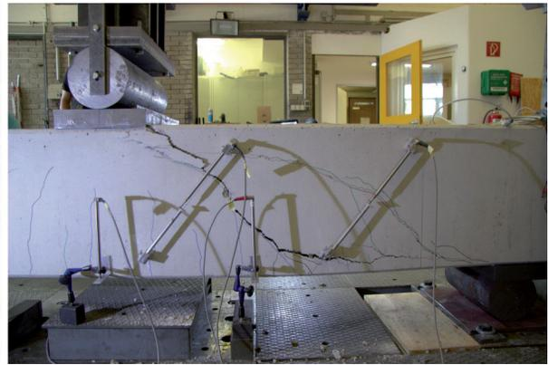
Bild 8 Bewehrungskörbe der Versuchsträger mit den verschiedenen untersuchten Anordnungen der Schubaufbiegungen und Versuchskörper im 3-Punkt-Biegeversuch mit Versagensbild und Messeinrichtung
