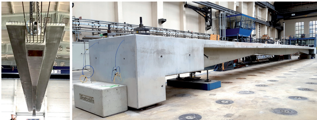
Bild 15 Halbfertigteil aus Carbonspannbeton (links) und fertiger Demonstrator (rechts)
