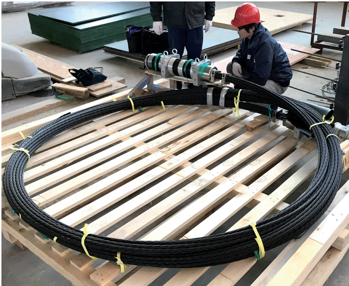
Bild 3 Carbonspannglied mit 12 Litzen und Vergusshülsen
