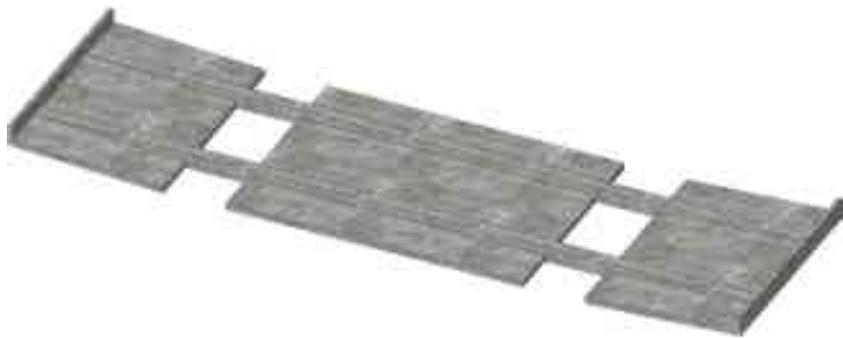
Bild 3 Betonfertigteil für die Herstellung der Fahrbahnplatte
