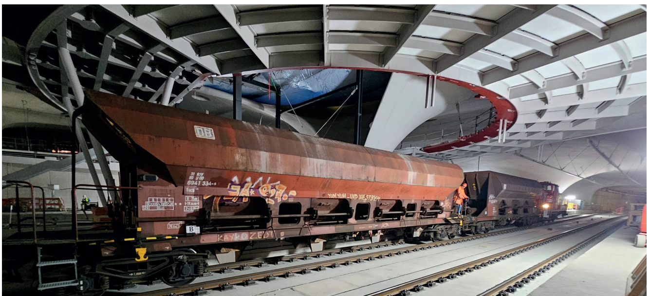
Bild 14: Belastungstest der Brückenkonstruktion mit Güterwaggons
