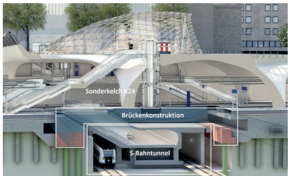
Bild 1: Überbrückung des S-Bahntunnels im Durchgangsbahnhof von S21
