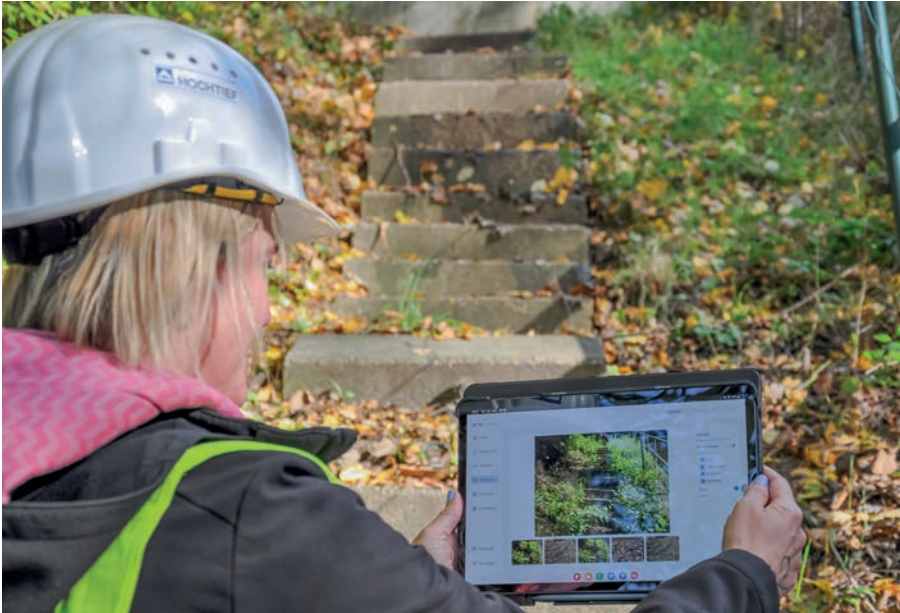
Bild 7: Schadensdokumentation mittels BridgeInspector-App
