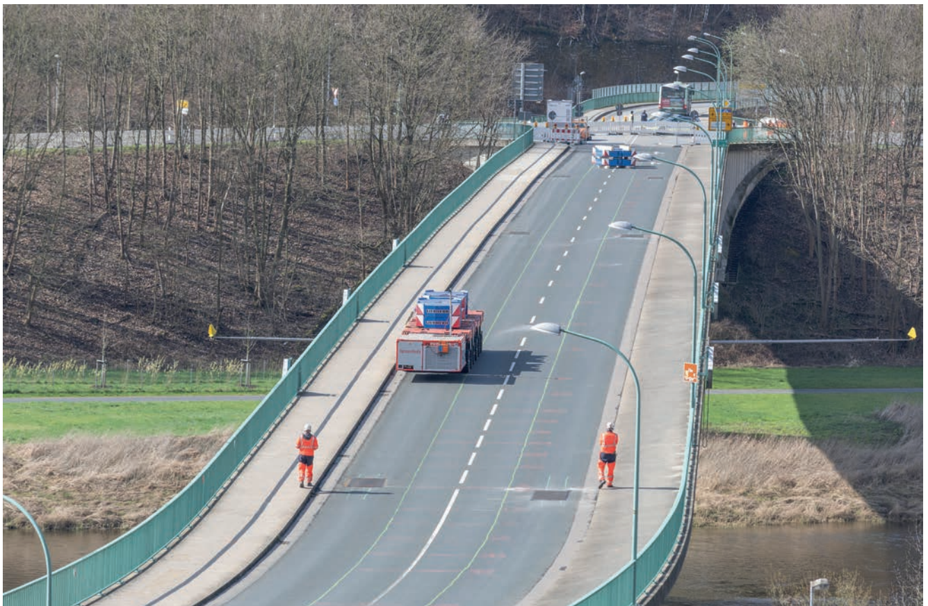
Bild 9: SPMT und Krangewichte auf Elbebrücke
