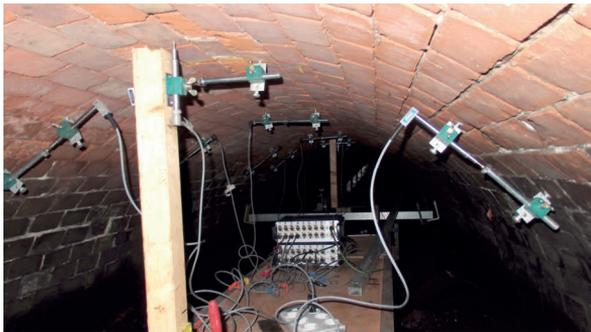
Bild 7 Dehnungs- und Durchbiegungsmessung im Gewölbe
