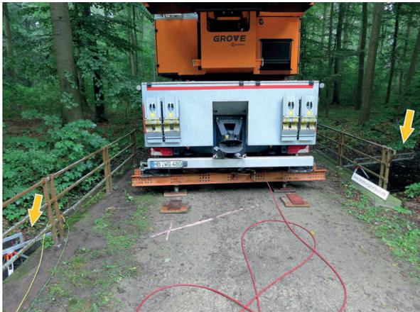
Bild 6 Lasteinleitung und Setzungsmessung (Pfeile)
