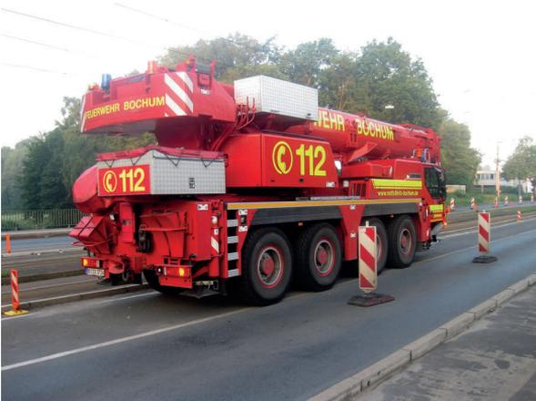
*Bild 9 Probelastung durch einen 48-t-Mobilkran*
