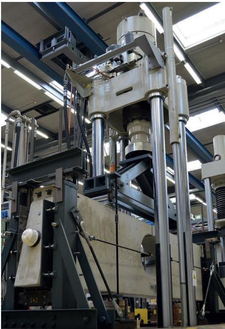
*Bild 4* Versuchsstand für die Ermüdungsversuche an der TU Dortmund
