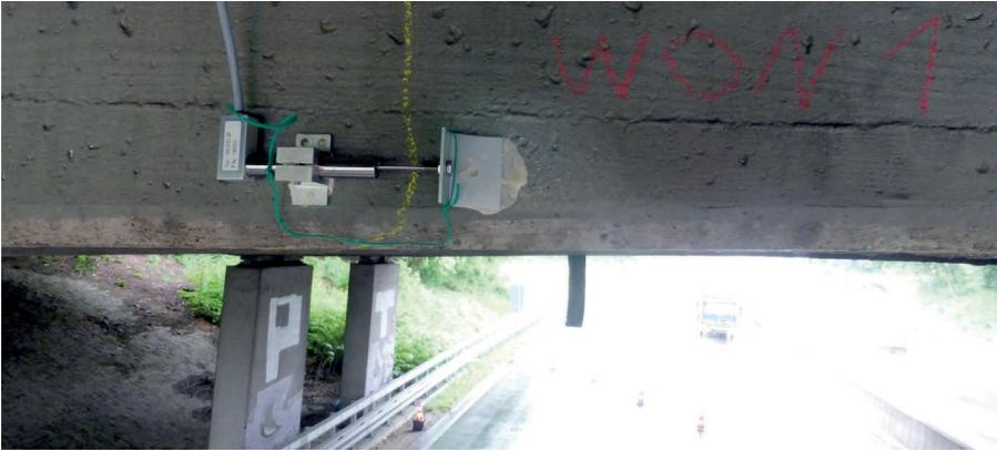
*Bild 8 Induktiver Wegaufnehmer an einer Messstelle am Bauwerk*
