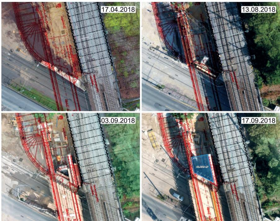
Bild 4 Orthomosaik unterschiedlicher Befliegungen mit hinterlegtem Planauszug am Widerlager Nord der EÜ
