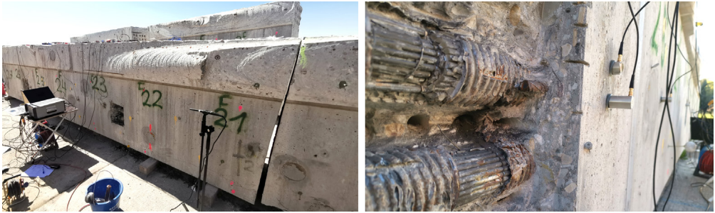
Bild 4: Trägerelement 2 (links) und Öffnung 1 an diesem mit angeklebten Sensoren (rechts)
