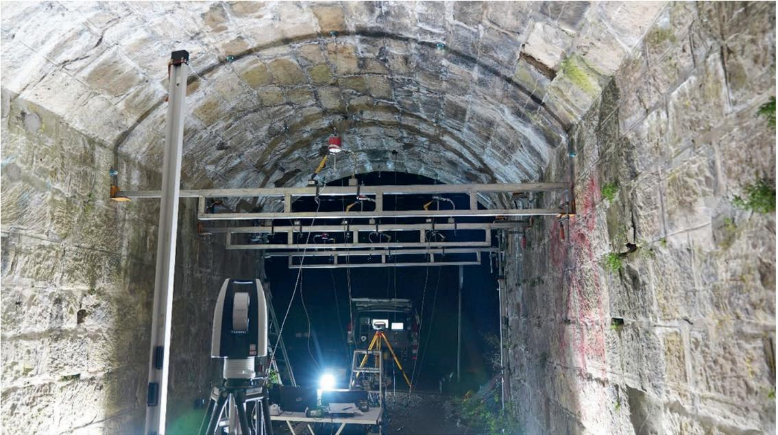
**Bild 3:** Messtechnik beim Belastungsversuch der Gewölbebrücke EÜ Straße
