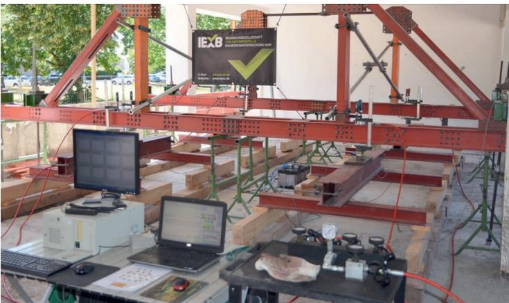
**Bild 9:** Belastungsrahmen und Onlinesmesstechnik
