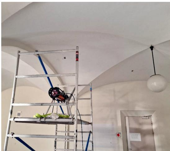
Bild 4: Durchstrahlung einer Eisenbetongewölbedecke
