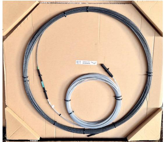
**Bild 4:** DFOS-Sensor (EpsilonSensor) im Anlieferungszustand auf der Baustelle
