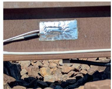
f) Temperatur-, Dehnungs- und Beschleunigungssensor Schiene
