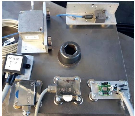
**Bild 14:** Untersuchte Beschleunigungssensoren
