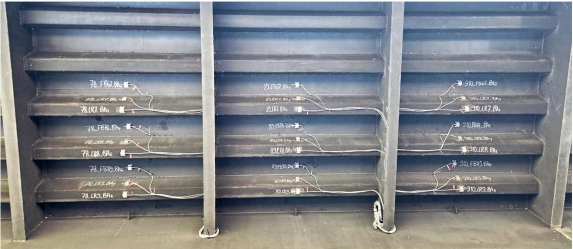
**Bild 13:** Zusätzlich installierte Beschleunigungsaufnehmer zur Verdichtung des Monitoringsystems an den Längssteifen 7, 8 und 9 an der Unterseite der Fahrbahn am TBW 1
