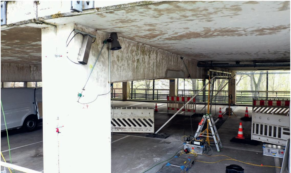
Bild 8: Messtechnik am Stockwerkrahmen
