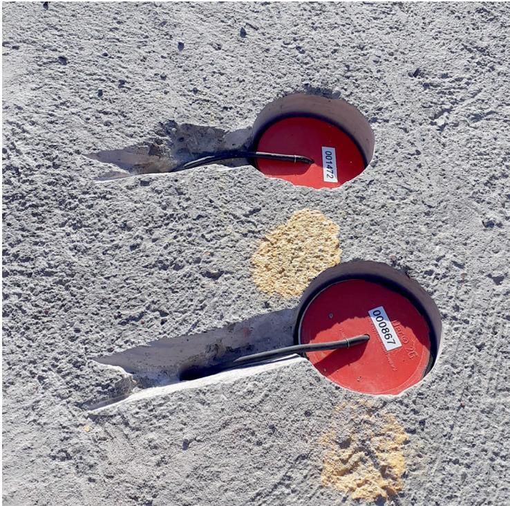
Bild 7: Eingebaute Sensoren mit abgesetzten Antennen
