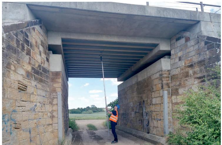
Bild 6: Montage bzw. Demontage des Messmittels
