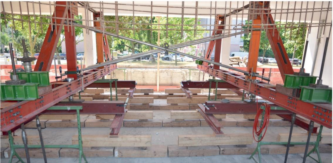
**Bild 8:** Belastungsrahmen und Lasteinleitung oberhalb der zu untersuchenden Deckenplatten
