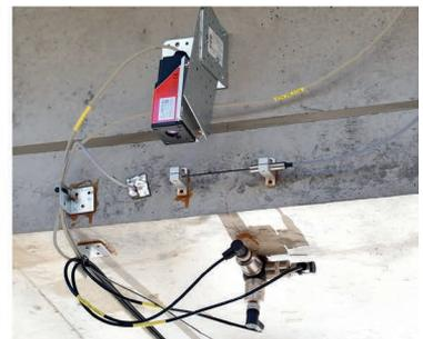
c) Durchbiegungs-, Beschleunigungs-, Bauteiltemperatur- und Biegedehnungssensoren
