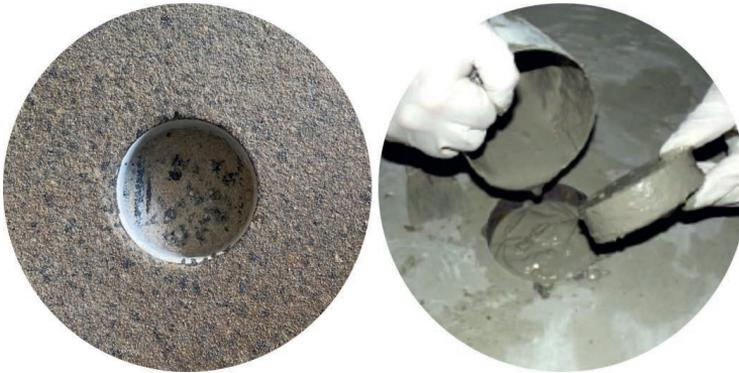
**Bild 3:** Kernlochbohrung mit einem Durchmesser von 100 mm und Einbau des Sensors mittels Ankoppelmörtel
