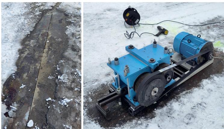
**Bild 15:** Eingebrochener 1 m langer Längsschnitt im Fahrbahndeckblech (links) und Anregung des TBW 1 mithilfe eines an der Fahrbahn befestigten Unwuchterregers (rechts)
