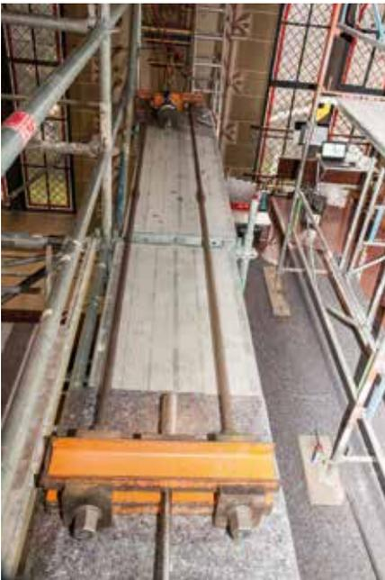
Bild 9: In das vorhandene Zugankersystem integriertes Lasteinleitungsgeschirr in Schnitt A-A (vgl. Bilder 2 und 8), [9]
