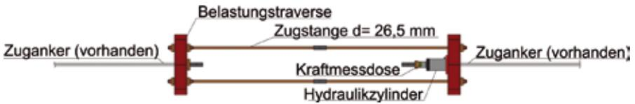
Bild 8: Lasteinleitungsgeschirr für die Einleitung der Zugkraft [9]
