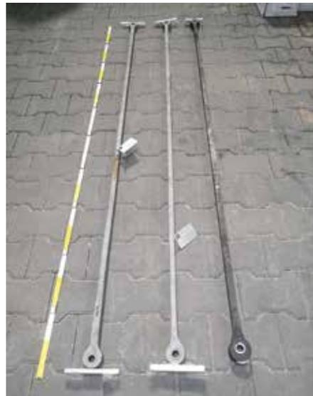
Bild 3: Ausgebauete Kettenglieder und rekonstruiertes Kettenglied (rechts)
