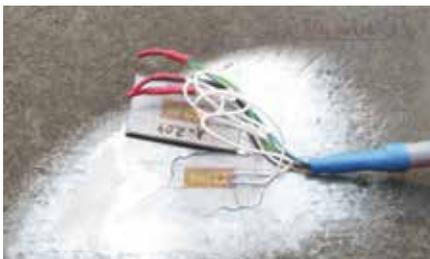
Bild 5: DMS mit 10 mm Messbasis und Temperaturkompensation an einer Stahlbrücke Foto: Nico Steffens
