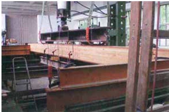
Bild 2: Belastungsversuch an der TU Dresden; zu erkennen sind die drei Durchbiegungsaufnehmer sowie die Lasteinleitung über einer lastverteilenden Traverse. Foto: TU Dresden
